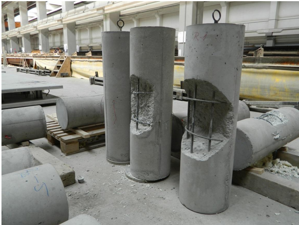
Slika 4. 12 Usporedni prikaz sa strane tri tipa oštećenja modela
