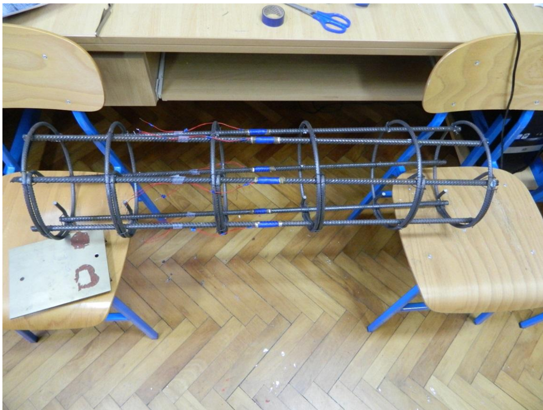
Slika 3. 12 Armaturni koš s instaliranim tenzometrima
