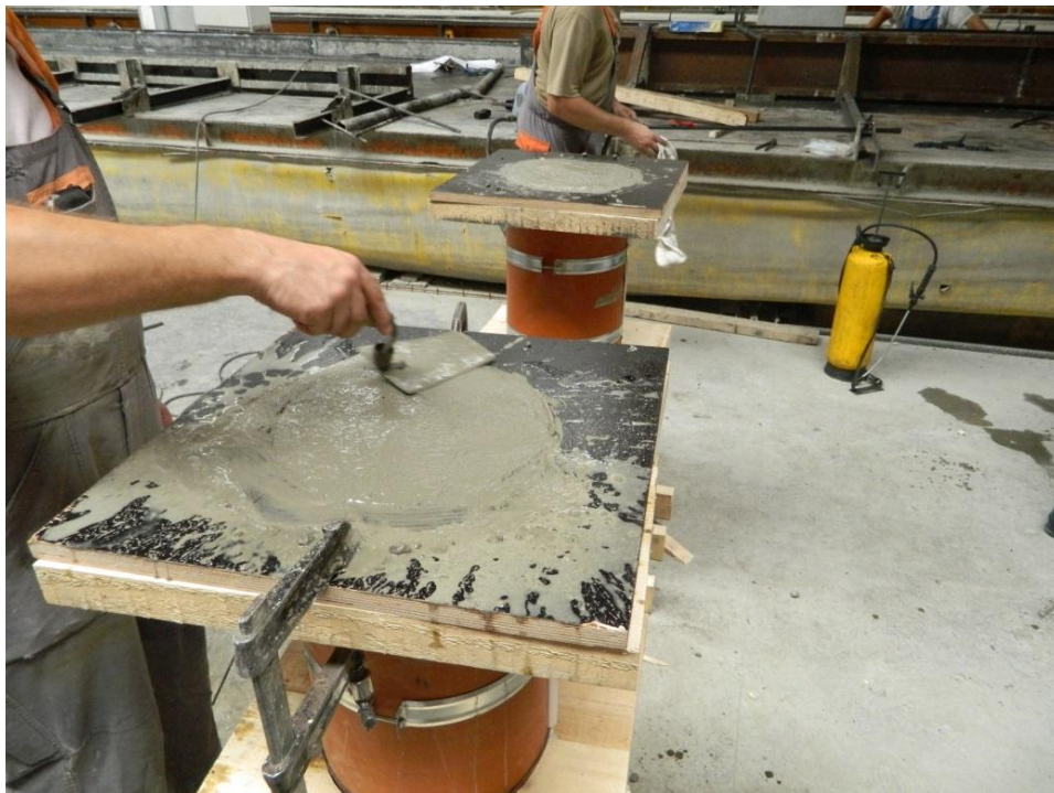
Slika 4. 7 Poravnanje vrha stupa zidarskom žlicom
