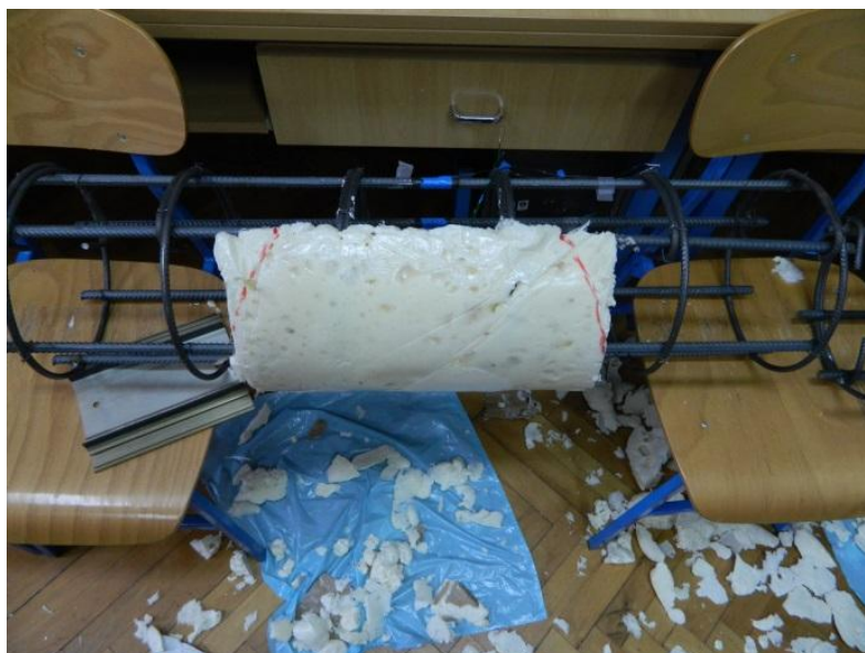
Slika 4. 2Obrada pur pjene na željeni dizajnirani oblik
