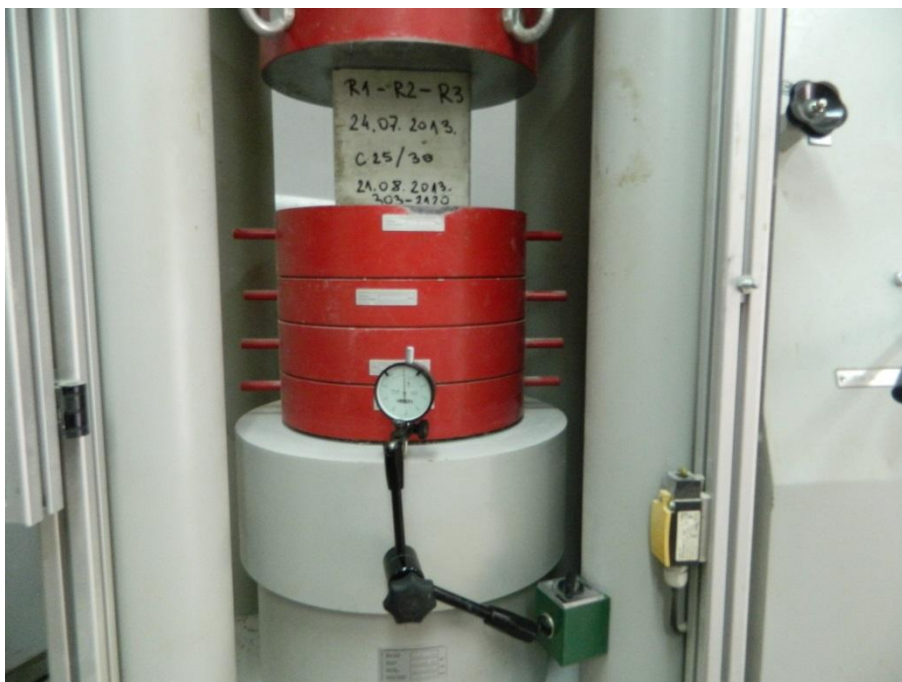
Slika 4. 15 Instalirana mikroura za praćenje pomaka/deformacija
