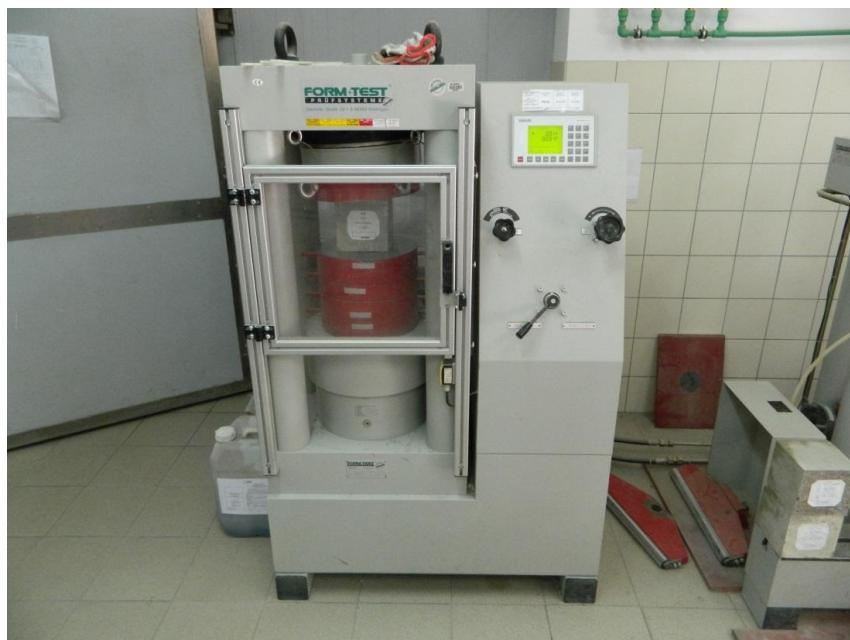
*Slika 4. 14 Automatska elektronička preša „Form-test“.*
