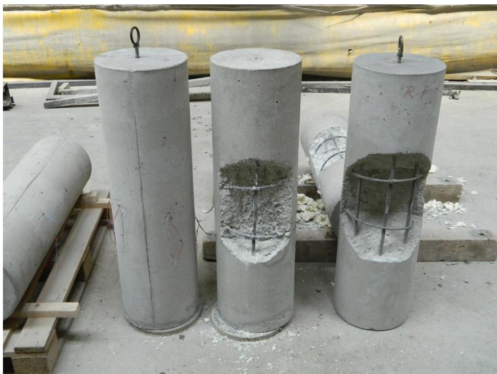
Slika 4. 13 Usporedni prikaz sprijeda tri tipa oštećenja modela
