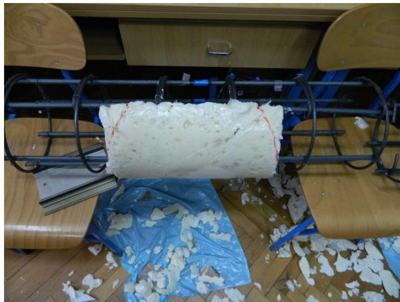
*Slika 4. 2Obrada pur pjene na željeni dizajnirani oblik*
