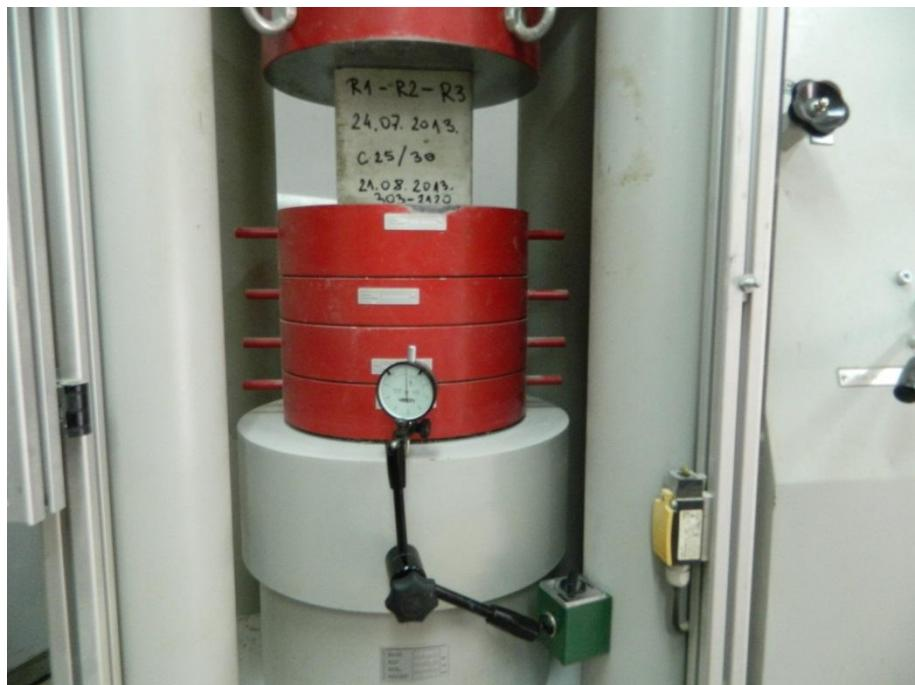
*Slika 4. 15 Instalirana mikroura za praćenje pomaka/deformacija*
