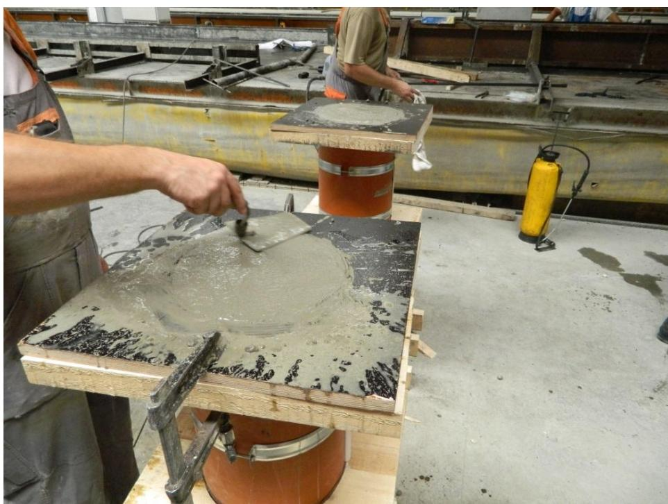
*Slika 4. 7Poravnjanje vrha stupa zidarskom žlicom*
