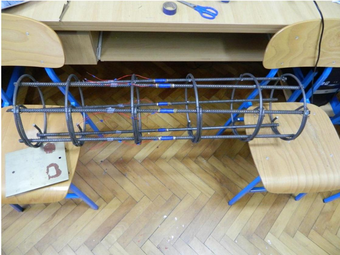
*Slika 3. 12Armturni koš s instaliranim tenzometrima*
