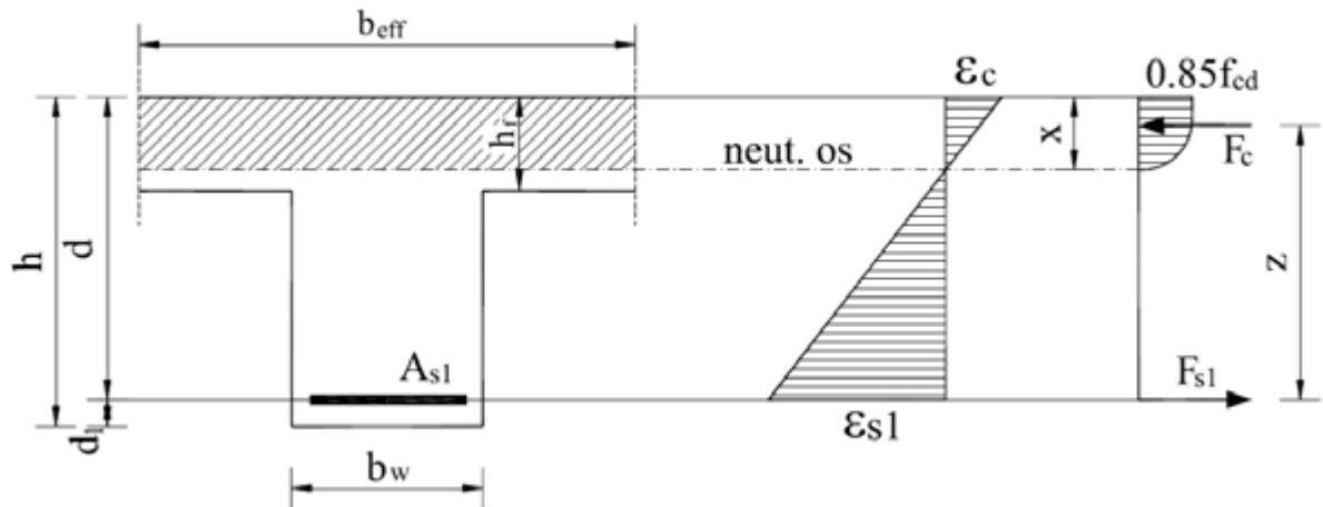
Slika 4.4 Dimenzioniranje T-presjeka na pozitivan moment savijanja
