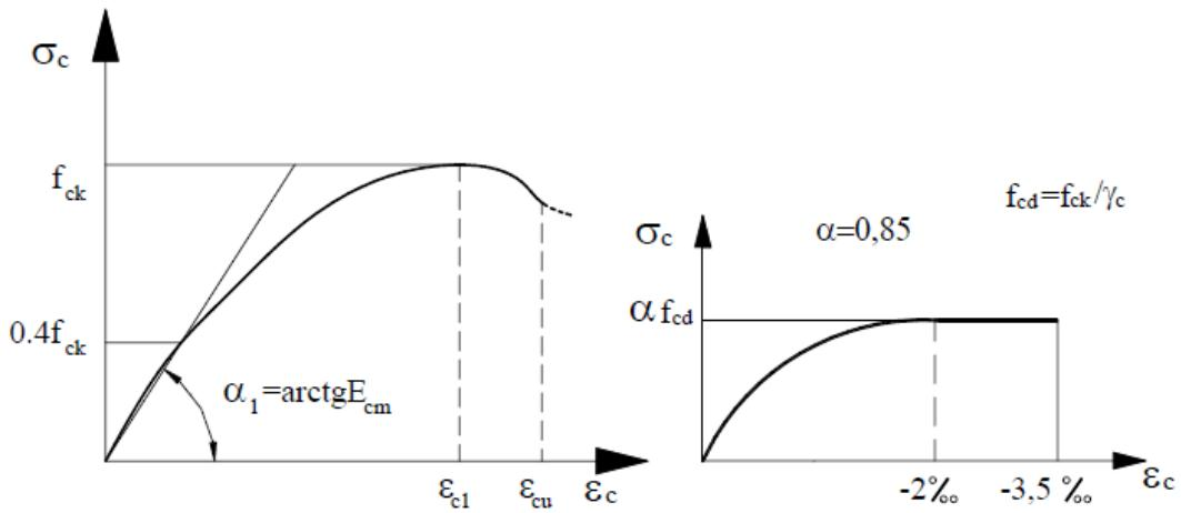
Slika 2.5 Radni (lijevo) i računski (desno) dijagram betona
