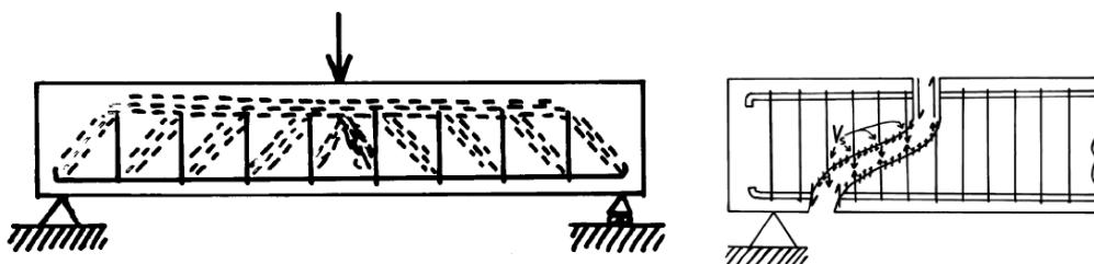
Slika 4.9 Mörscrova rešetka – nosivi mehanizam sa vertikalnim sponama
