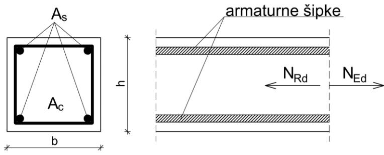
*Slika 4.8 Poprečni presjek naprezan centričnom vlačnom silom*
