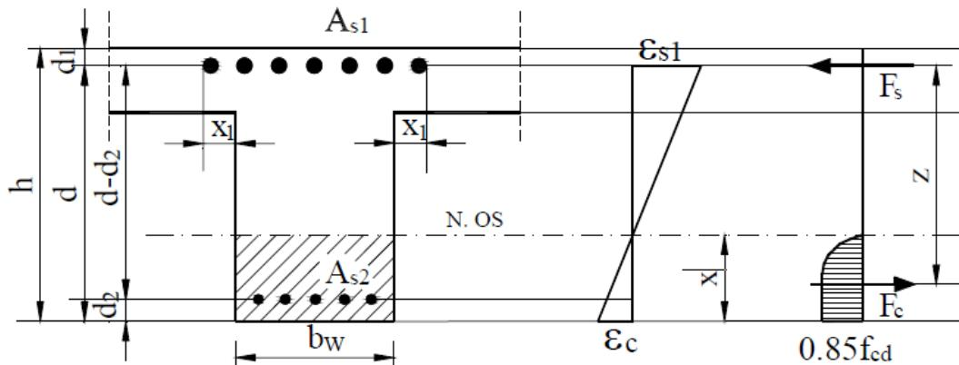
Slika 4.2 Dvostruko armirani presjek za negativni moment savijanja
