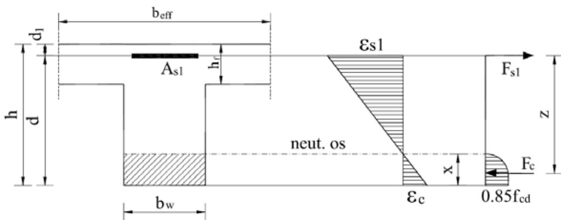
Slika 4.5 Dimenzioniranje T-presjeka na negativan moment savijanja
