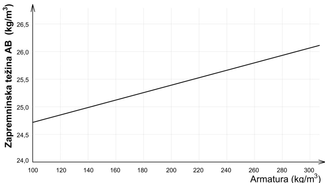
Slika 2.7 Utjecaj količine armature na zapreminsку težinu armiranog betona
