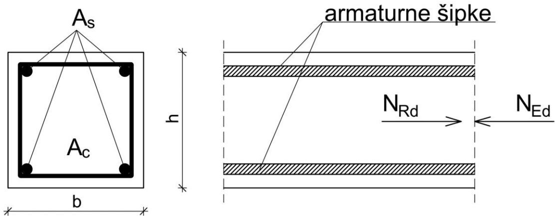
Slika 4.6 Poprečni presjek naprezan centričnom tlačnom silom
