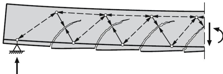
Slika 4.10 Mörscrova rešetka – nosivi mehanizam sa kosim sponama
