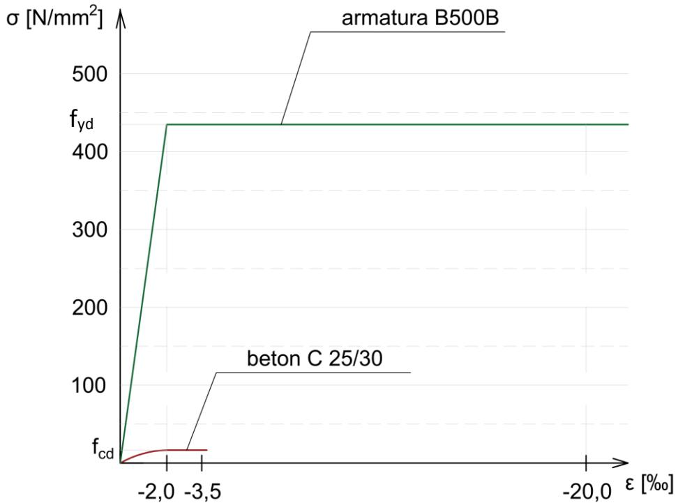
Slika 2.9 Računski dijagram na kojemmo možemo vidjeti usporedbu između armature tipa B500B i betona tlačne čvrstoće C 25/30
