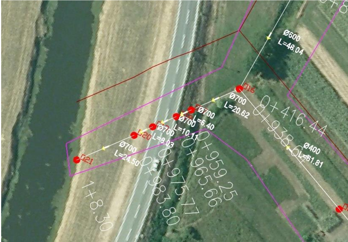
Slika 3.2.3.1.: Glavni kolektor sustava C na trasi od čvora O16 do čvora O21 neposredno pred rijeku Krapinu
