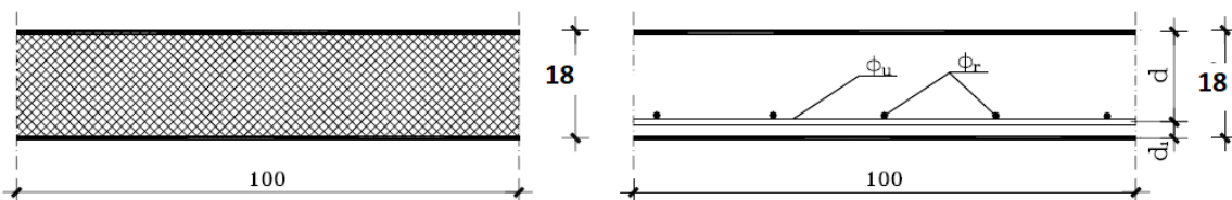
Slika 30. Poprečni presjek ploče, statička visina presjeka
