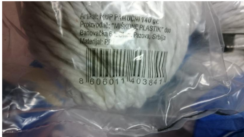
Slika 4.37. Bar kod bez podloge i „razlijanih“ linija
