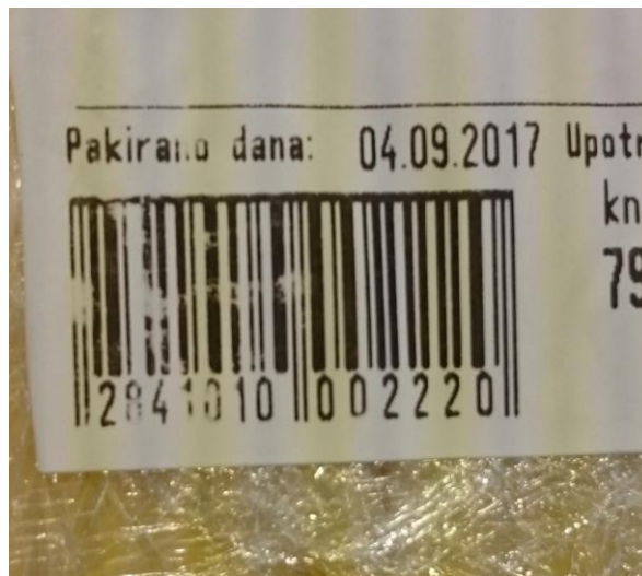
Slika 4.43. Oštećenje nastalo kemijskom reakcijom kiseline
