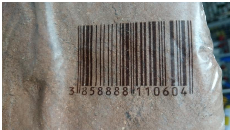
Slika 4.42. Nedostatak podloge bar kodu
