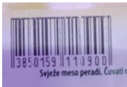
Slika 4.8. Bar kod sa nedostatkom dvije linije
