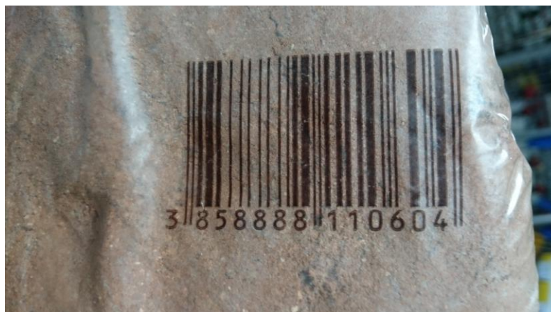
Slika 4.42. Nedostatak podloge bar kodu
