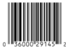
Slika 3.2. Linearni UPC-A bar kod [14]
