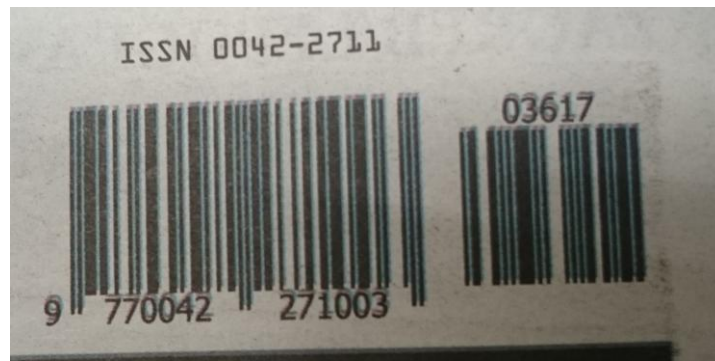
Slika 4.35. Duple linije koda na novinama
