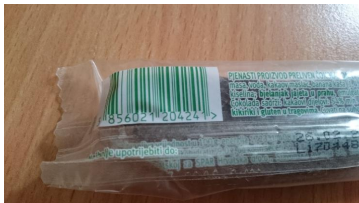
Slika 4.18. Bar kod podložen gnječanju
