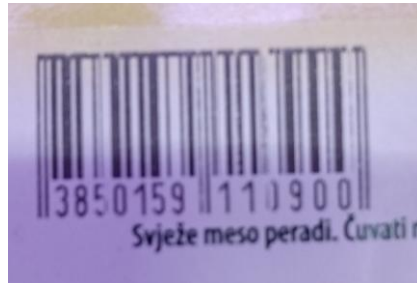
Slika 4.8. Bar kod sa nedostatkom dvije linije
