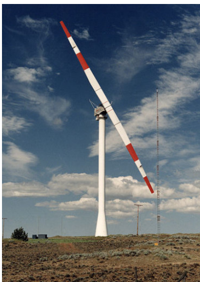
Slika 4.5 Vjetroturbina s dvije lopatice[19]
