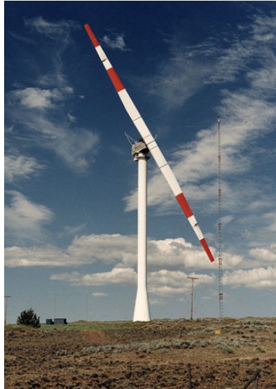
Slika 4.5 Vjetroturbina s dvije lopatice[19]
