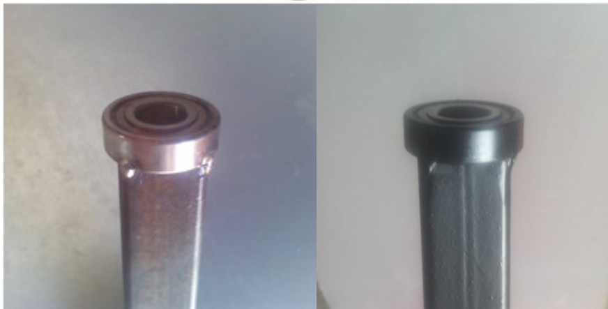
Slika 5.5 Ležaj i položaj ležaja na vrhu stupa
