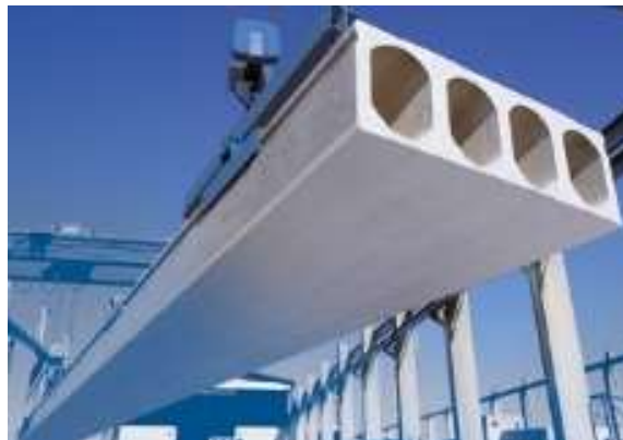
Slika 1.1. Izgled elementa prednapregnute šuplje ploče
