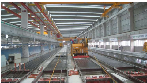
Slika 3.4. Prikaz strojno istiskivanje betonske mješavine
