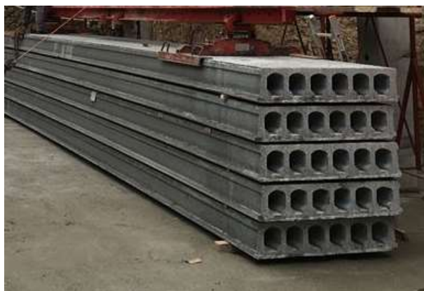
Slika 3.5. Gotove prednapregnute šuplje ploče
