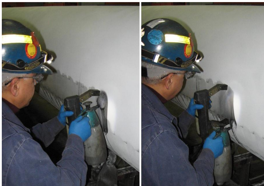
Slika 8. Ispitivanje magnetnim česticama [5]
