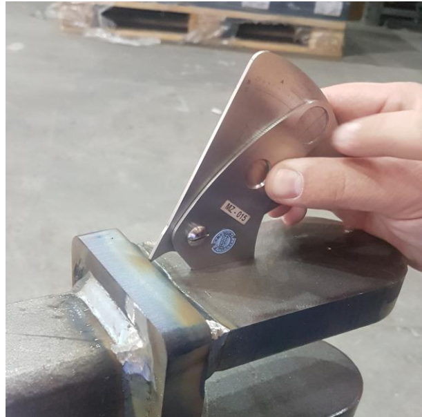
Slika 32. Kontrola dimenzija zavarenog spoja
