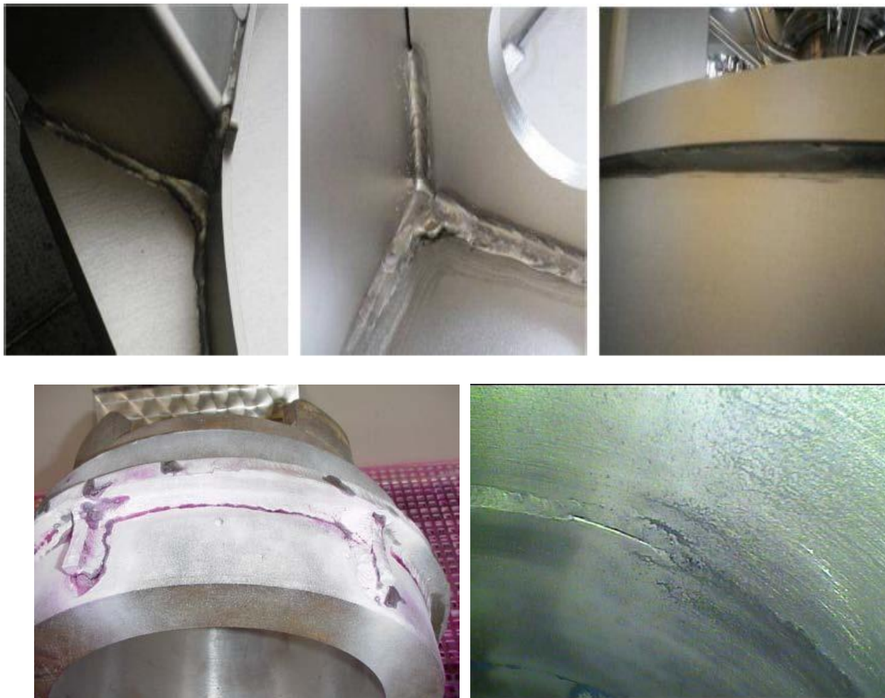
Slika 40. Pogreška u vezivanju i slaba provarenost
