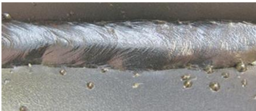
Slika 42. Prskotine od zavarivanja
