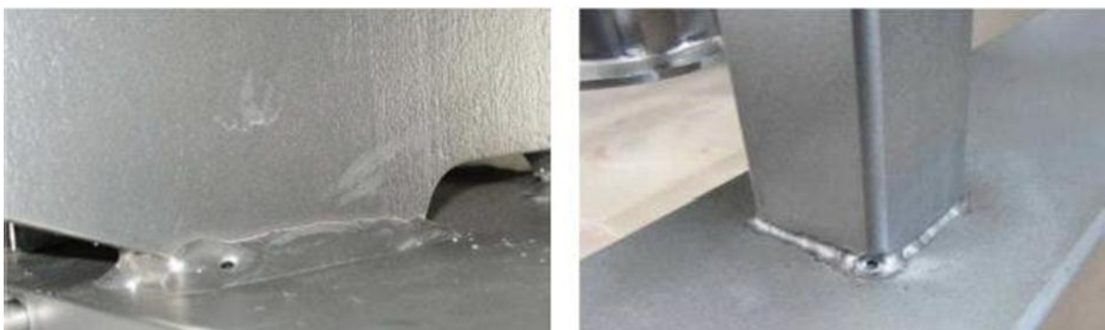
Slika 39. Pojedinačne pore i rupe u zavaru
