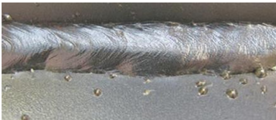
Slika 42. Prskotine od zavarivanja
