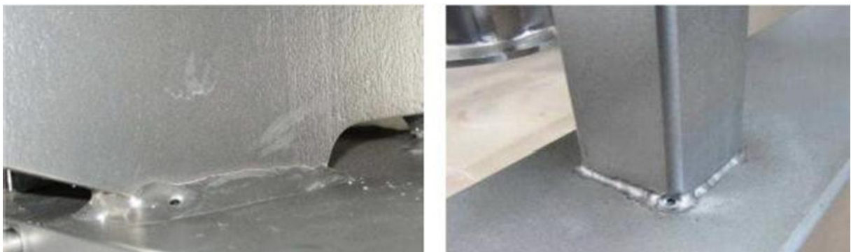
Slika 39. Pojedinačne pore i rupe u zavaru
