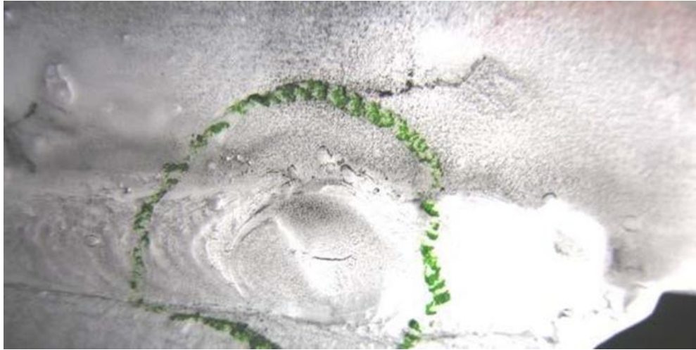
Slika 36. Pukotina u krateru
