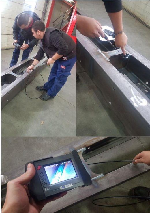
Slika 5. Postupak provođenja vizualne kontrole
