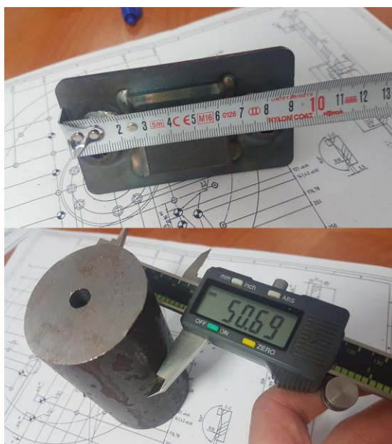
Slika 6. Postupak provođenja dimenzionalne kontrole
