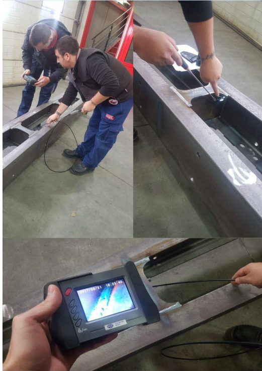
Slika 5. Postupak provođenja vizualne kontrole
