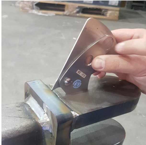
Slika 32. Kontrola dimenzija zavarenog spoja
