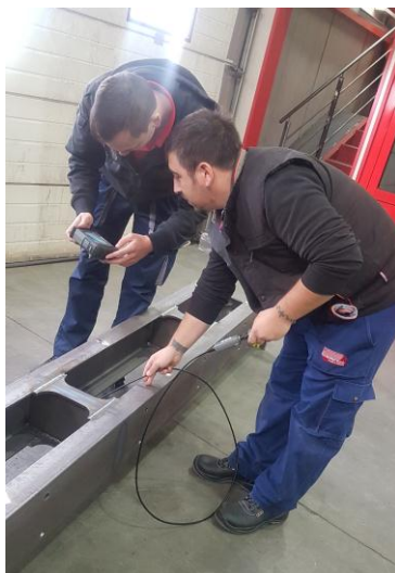
Slika 13. Provođenje vizualne kontrole
