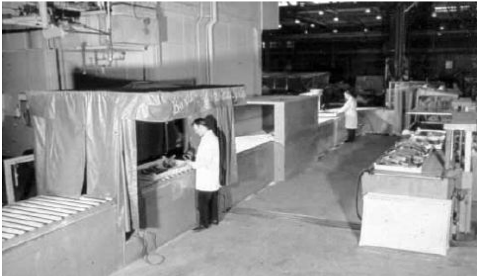
Slika 4. Radna jedinica za ispitivanje penetrantima [1]
