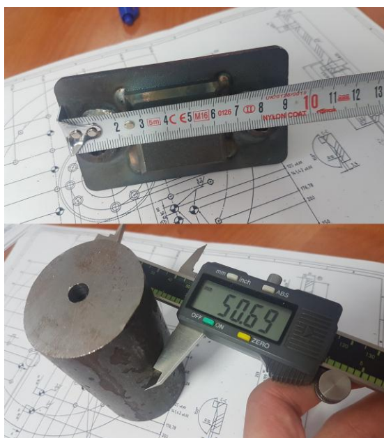
Slika 6. Postupak provođenja dimenzionalne kontrole
