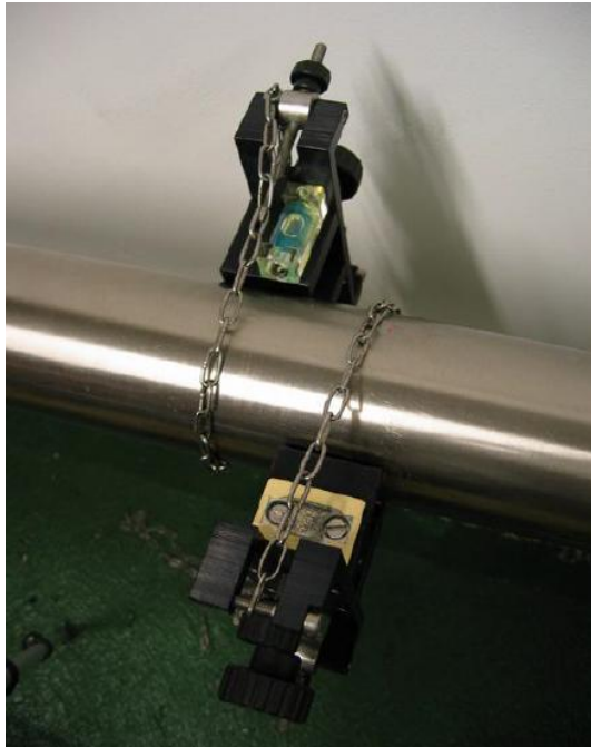
Slika3.19 Poravnavanje nosača u Z režimu[2]
