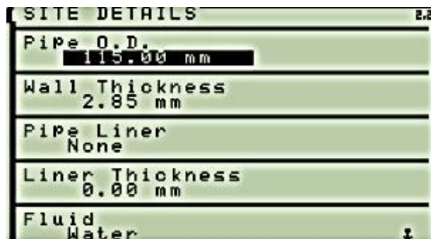
Slika 3.14 Upisivanje parametara, ChronoFLO 2[2]
