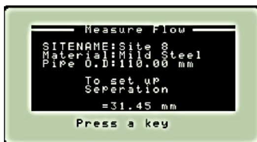
Slika 3.16 Izračun udaljenosti između pretvornika, ChronoFLO[2]
