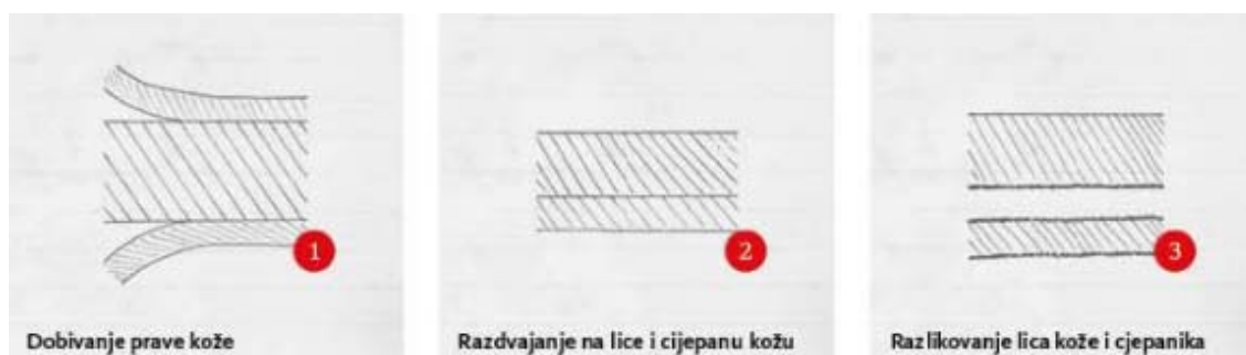
Slika 16. Proces obrade kože
