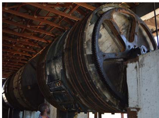
Slika 18. Bubanji za štavljenje
