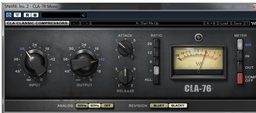
Slika 5.4: Postavke kompresora CLA-76 Mono za bas gitaru
