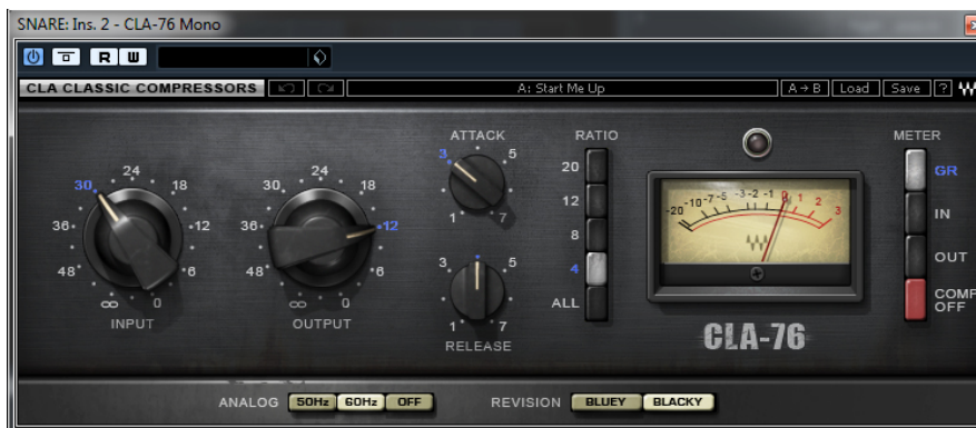
Slika 5.4: Postavke kompresora CLA-76 Mono za bas gitaru
