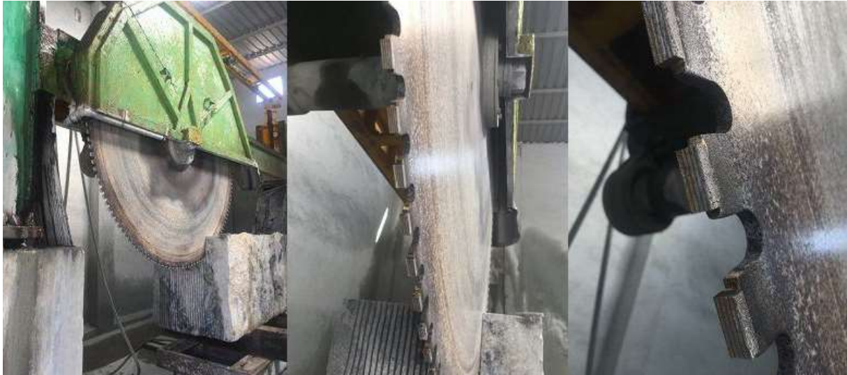
Slika 12. Piljenje kamenih blokova
