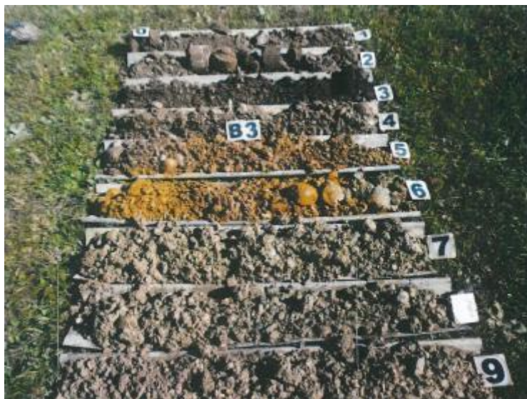
Slika 5. Primjer jezgre istražnih bušotina s oznakama dubine iz geotehničkog elaborata
