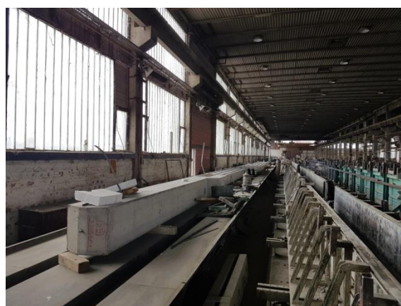
Slika 53. AB stup i oplata za AB stup
