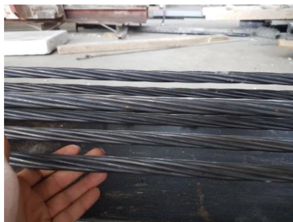
Slika 55. Čelične sajle za prednapinjanje AB konstrukcija
