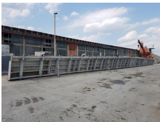
Slika 60. Kalup za A nosač
