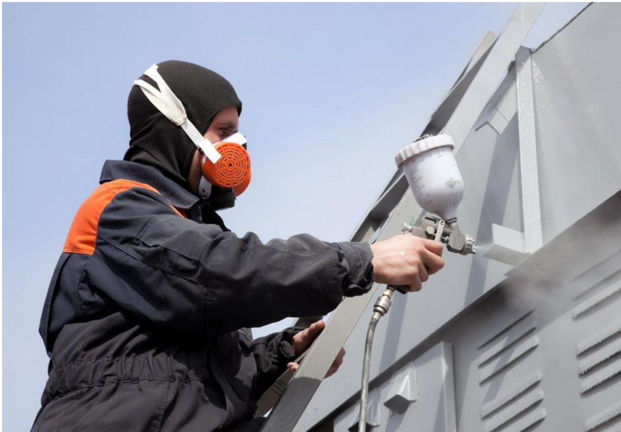
Slika 11. Nanošenje premaza prskanjem [15]
