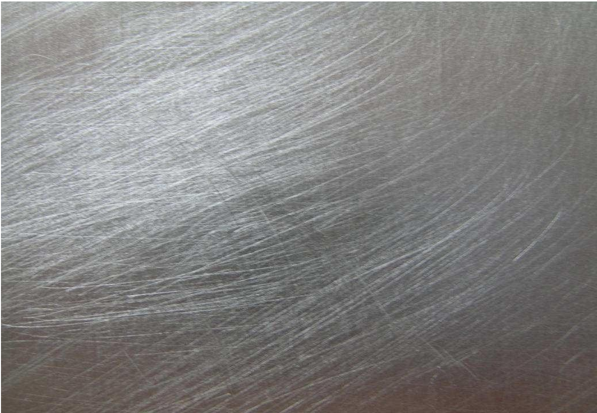
Slika 6. Mehanički očišćeni dekapirani čelični lim
