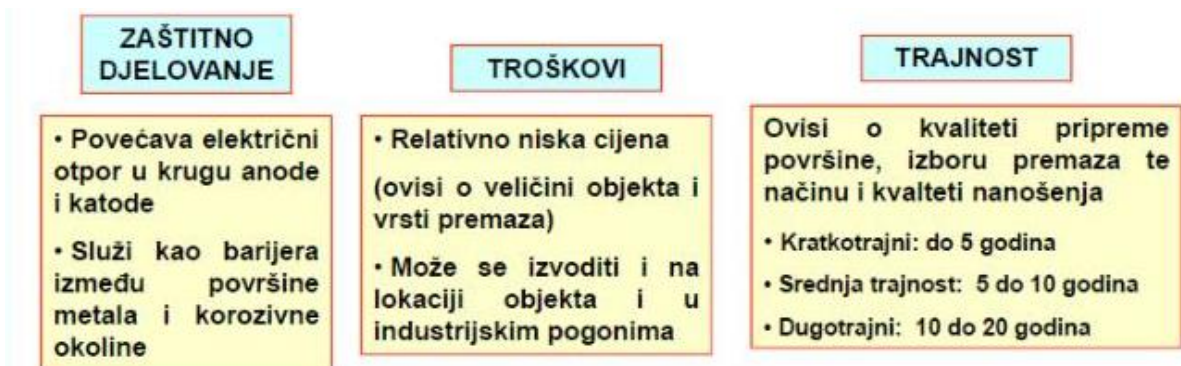
Slika 4. Zaštita metala od korozije organskim premazima [4]
