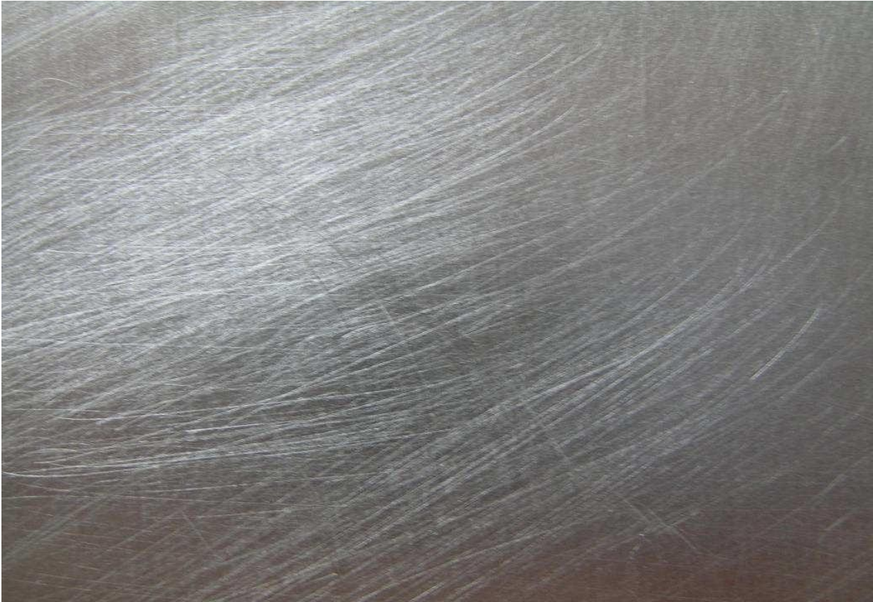
Slika 6. Mehanički očišćeni dekapirani čelični lim
