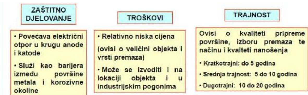
Slika 4. Zaštita metala od korozije organskim premazima [4]
