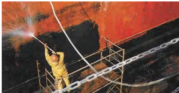
Slika 7. Vodeno pjeskarenje vanjske površine broda
