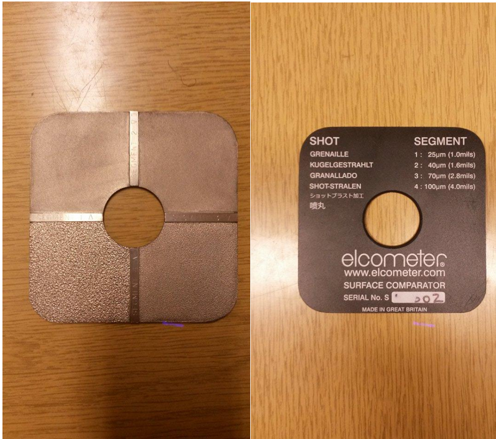
Slika 13. Usporedna pločica – komparator
