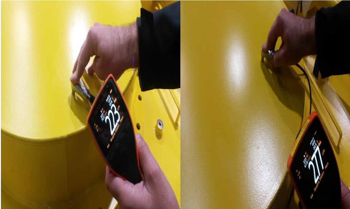
Slika 20. Mjerenje debljine suhog filma završnog sloja
