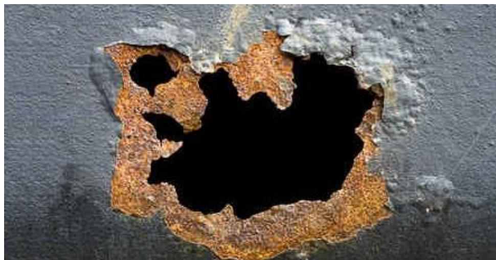
*Slika 1. Pukotina nastala djelovanjem korozije na ugljičnom čeliku [13]*
