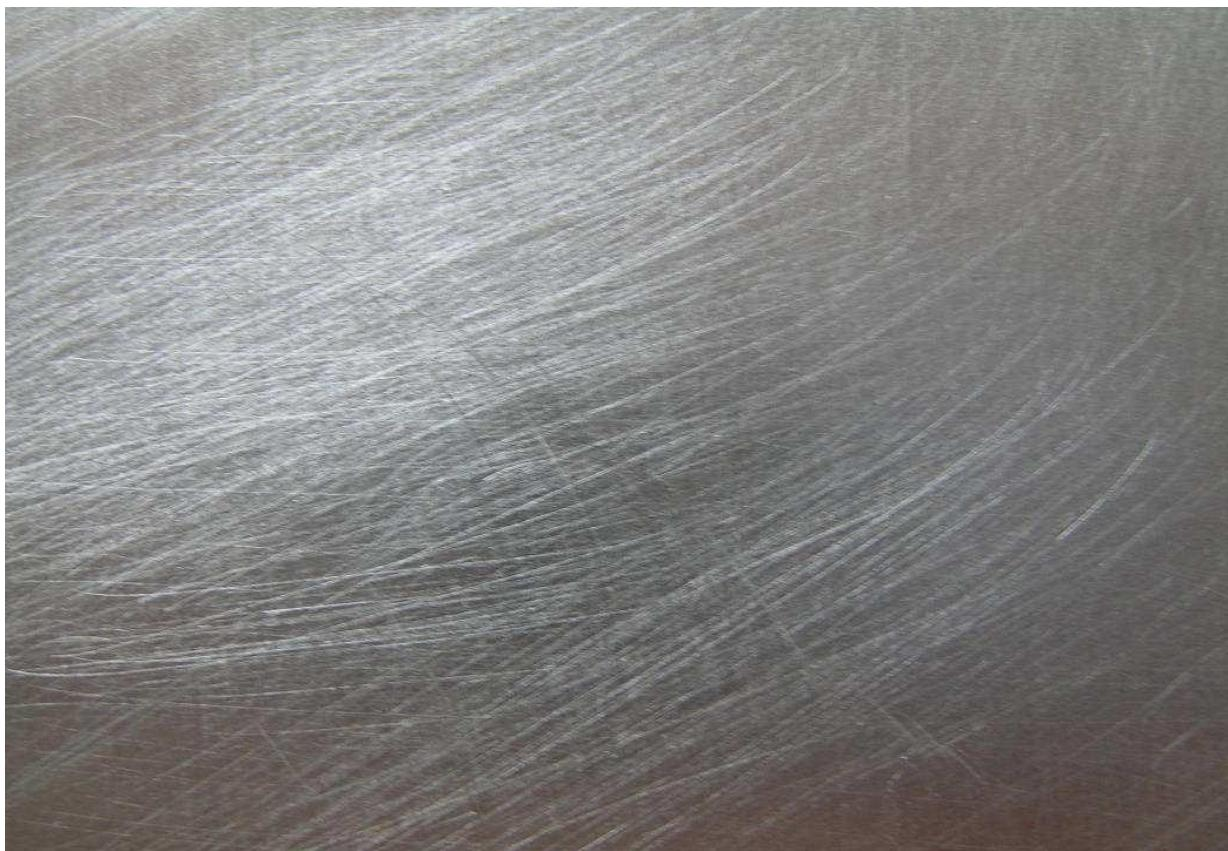
*Slika 6. Mehanički očišćeni dekapirani čelični lim*
