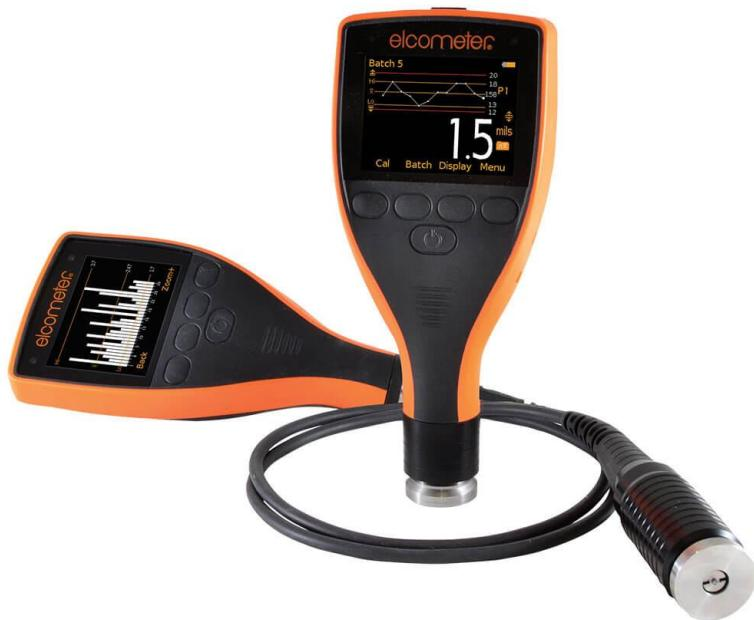
*Slika 15. Elcometer 224 koji mjeri debljinu suhog filma premaza i radi na principu vrtložnih struja [14]*
