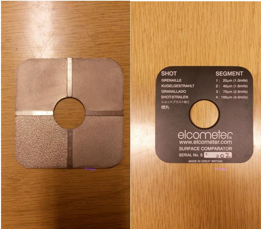
*Slika 13. Usporedna pločica – komparator*
