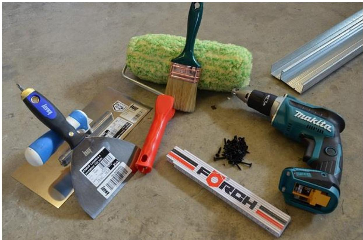
Slika 5.12. Alat za izvođenje suhomontažnih radova
