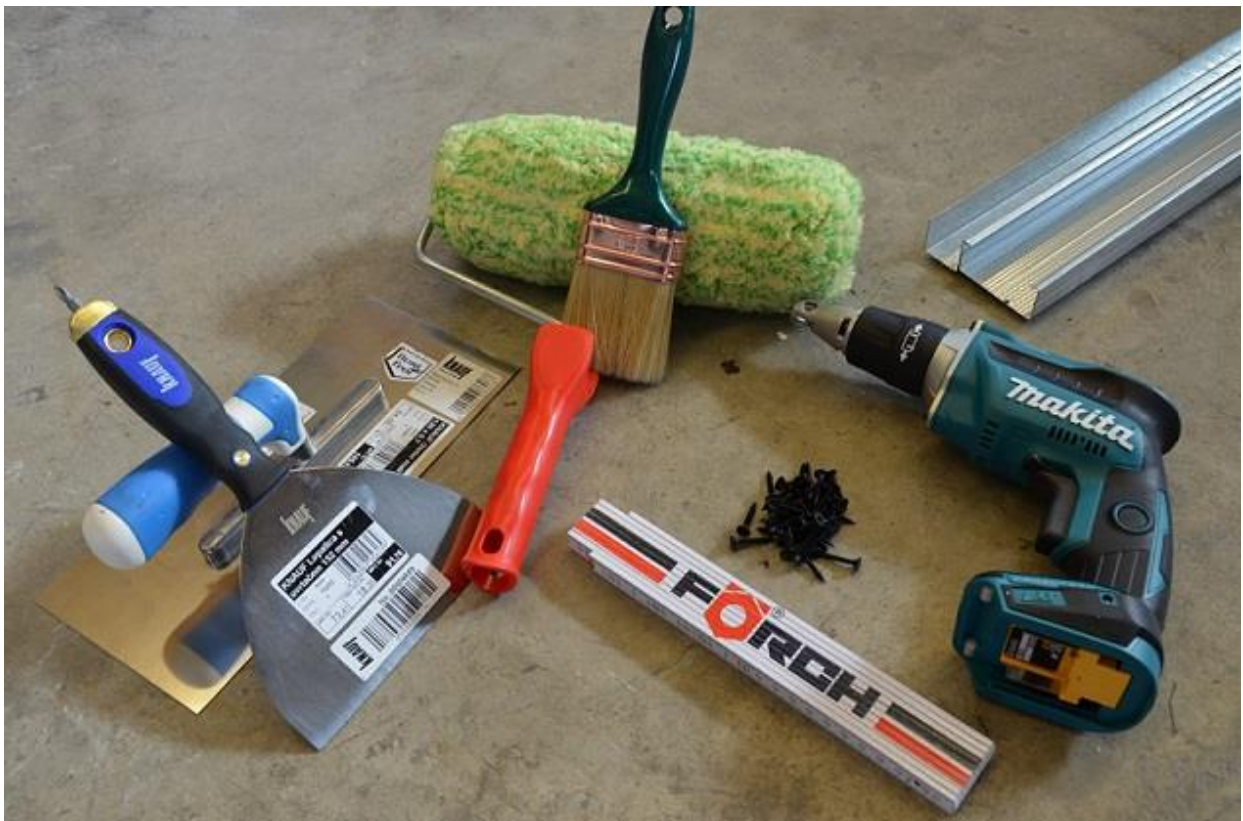
Slika 5.12. Alat za izvođenje suhomontažnih radova
