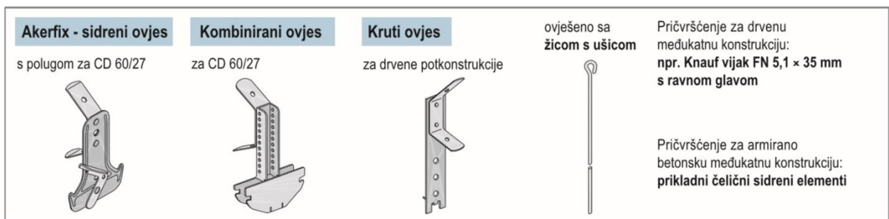
Slika 5.8. Prikaz sidrenog, kombiniranog i krutog ovjesa te žice sa ušicom
