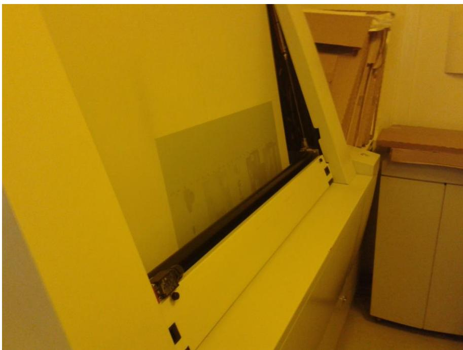
Slika 8-Osvjetljavanje tiskovne forme
