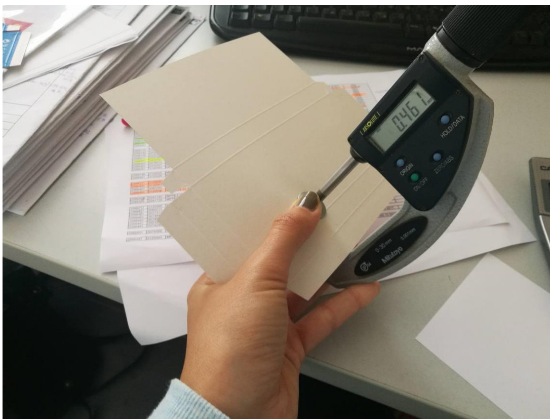
Slika 18-Mjerenje debljine kartona mikrometrom
