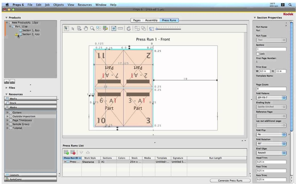
Slika 4-Program Preps za montažu elemenata na tiskovni arak
