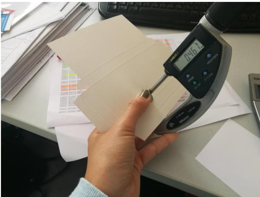
Slika 18-Mjerenje debljine kartona mikrometrom
