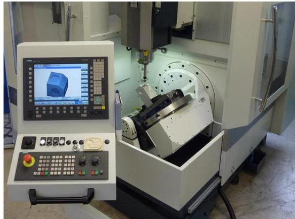
Slika 4.2 Slika konzole Siemens SINUMERIK 840D [8]
