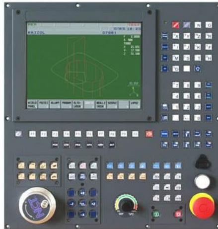
Slika 6.17 NCT 101 upravljačka jedinica [31]
