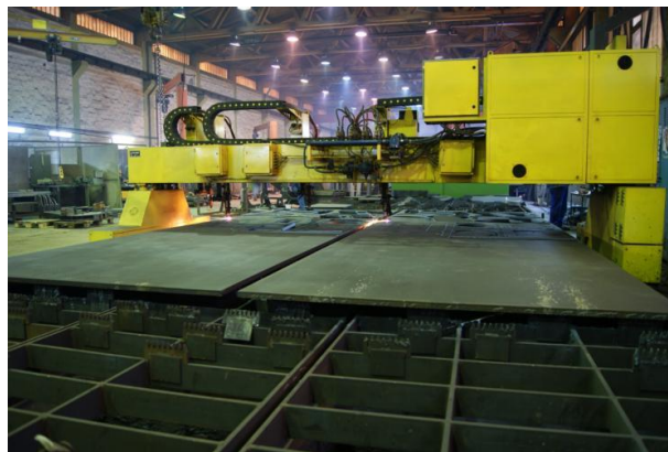
Slika 4.4 Plinski laser Numotaj [4]
