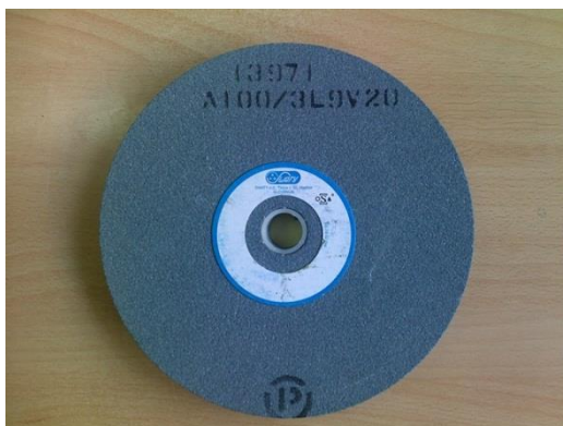
Slika 4.7 Brusna ploča za stolnu brusilicu ( 200 x 20 x 20 ) [5]
