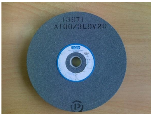
Slika 4.7 Brusna ploča za stolnu brusilicu ( 200 x 20 x 20 ) [5]
