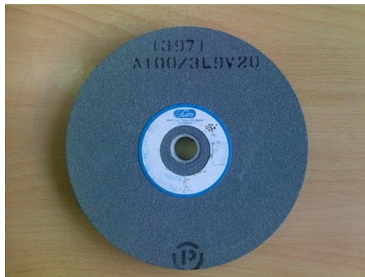
Slika 4.7 Brusna ploča za stolnu brusilicu ( 200 x 20 x 20 ) [5]
