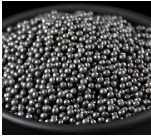
Slika 4.3 Čelična sačma za sačmarenje [2]
