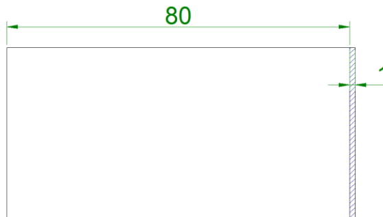
Slika 4.31 Poprečno tokarenje kocke
