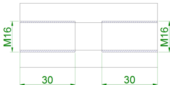
Slika 4.26 Urezivanje navoja M16
