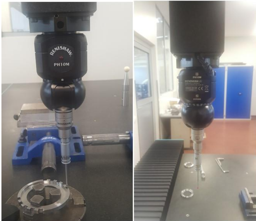
Slika 24. Renishaw PH10M mjerna sonda
