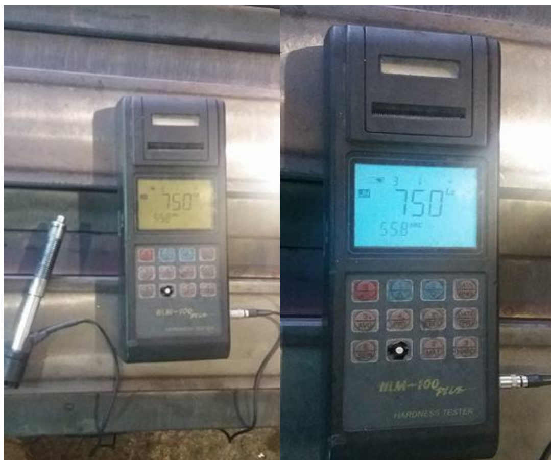
Slika 26. Uređaj za mjerenje tvrdoće (HLM-100 PLUS)
