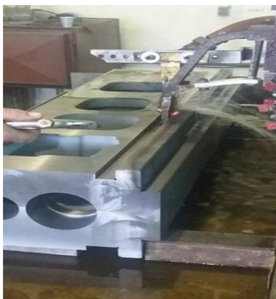
Slika 25. Indukcijsko kaljenje vodilica
