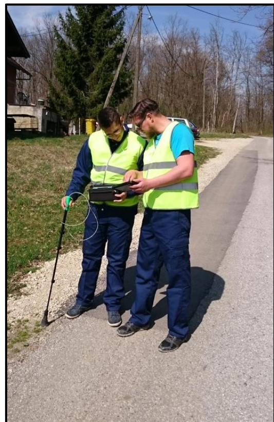
Slika 4.6 Prikaz ispitivanja nepropusnosti operativnih ekipa na terenu
