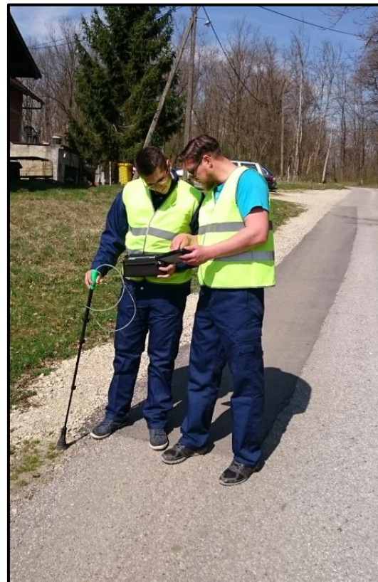
Slika 4.6 Prikaz ispitivanja nepropusnosti operativnih ekipa na terenu
