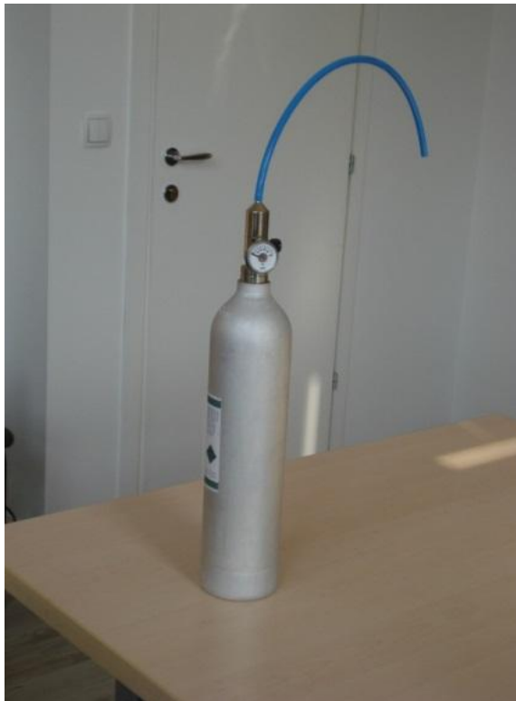
Slika 4.11 Test boca za provjeru ispravnosti uređaja
