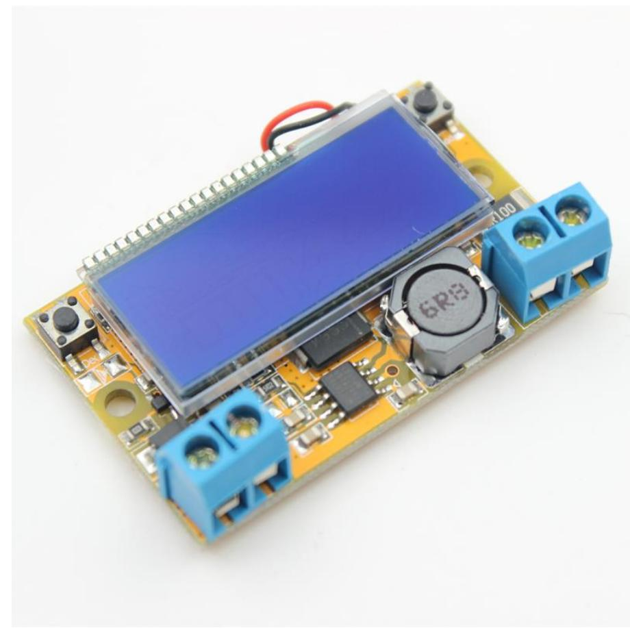
Slika 3.13 DC-DC pretvarač s ugrađenim LCD ekranom [12]
