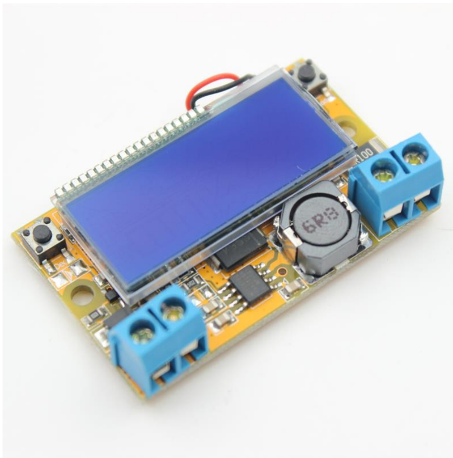
Slika 3.13 DC-DC pretvarač s ugrađenim LCD ekranom [12]
