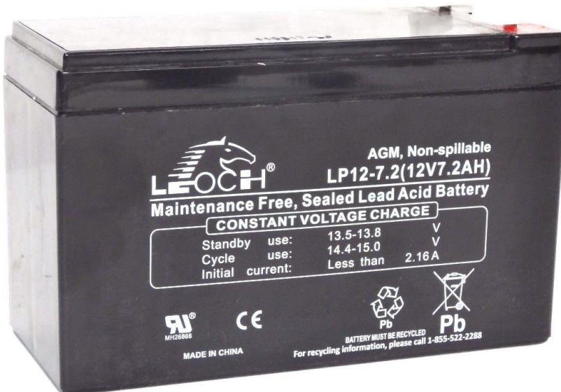
Slika 4.1 Olovni akumulator 12 V 7.2 Ah [19]
