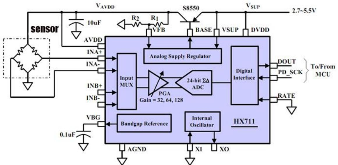
Slika 3.6 Blok diagram A/D modula [5]
