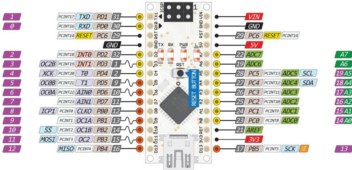
Slika 3.1 Arduino pinout
