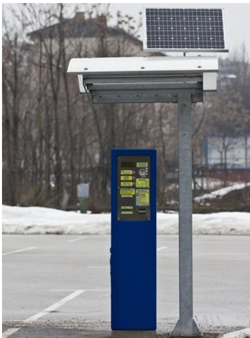
Slika 4.2. Parkirališni automati sa solarnim modulima [45]
