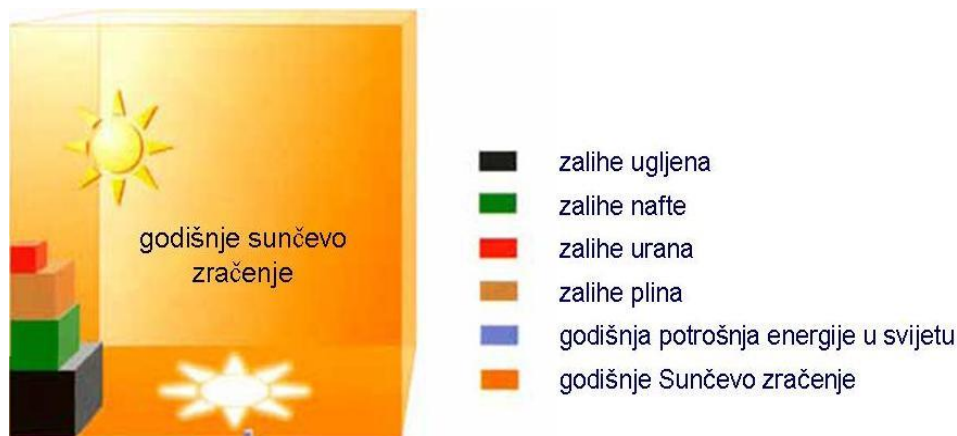
Slika 2.2. Godišnja usporedba Sunčevog zračenja na površini Zemlje s godišnjom potrošnjom energije u svijetu, te zalihama fosilnih i nuklearnih goriva [36]
