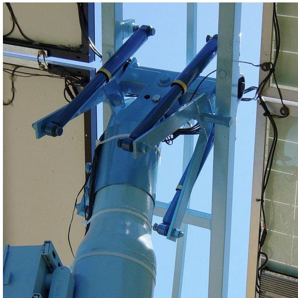
Slika 5.10. Glava Zomework-ovog pasivnog sustava za praćenje Sunca [54]
