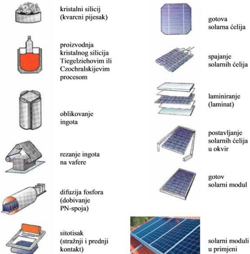
*Slika 3.5. Postupak proizvodnje solarnih čelija i solarnog modula [8]*
