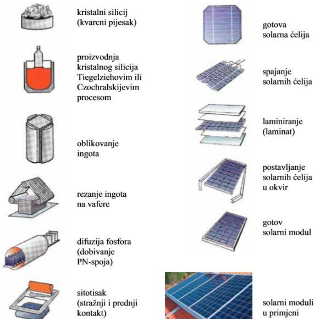
Slika 3.5. Postupak proizvodnje solarnih ćelija i solarnog modula [8]
