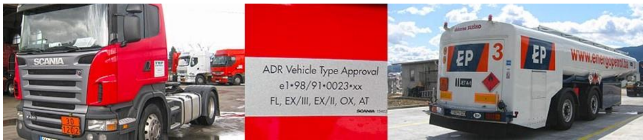
Slika 1. Cisterna za prijevoz opasnih tvari
