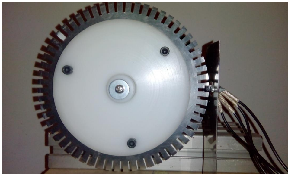
Slika 10. Montaža nazubljenog diska i senzora na osovinu motora
