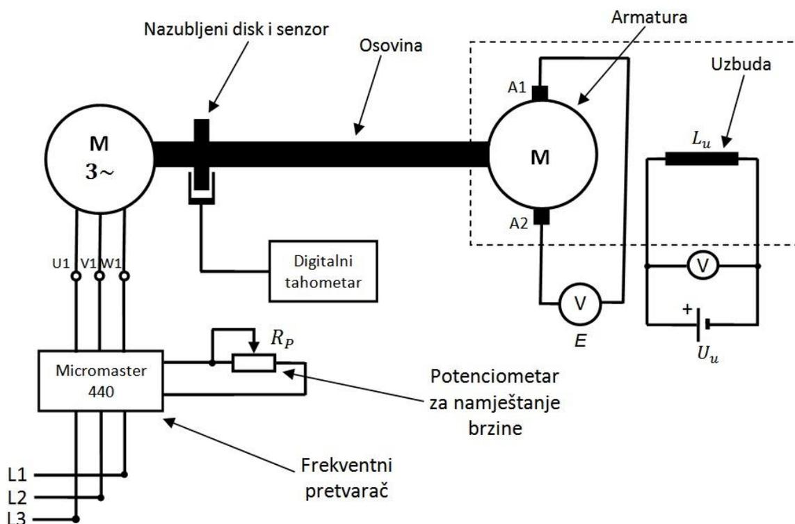
Slika 30. Shema spoja kod određivanja statičke karakteristike sustava
