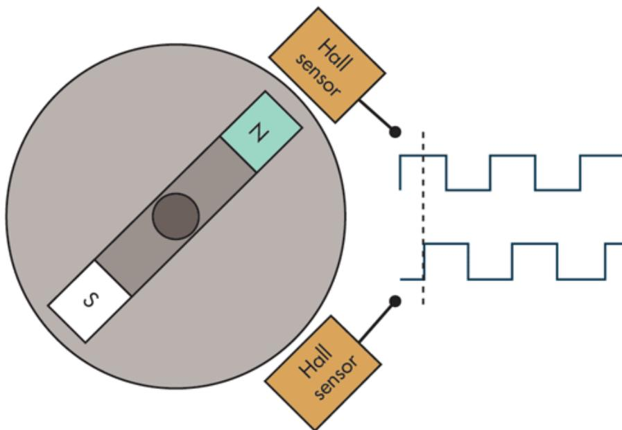
Slika 8. Inkrementalni enkoder s dva Hallova pretvarača (generatora)[7]
