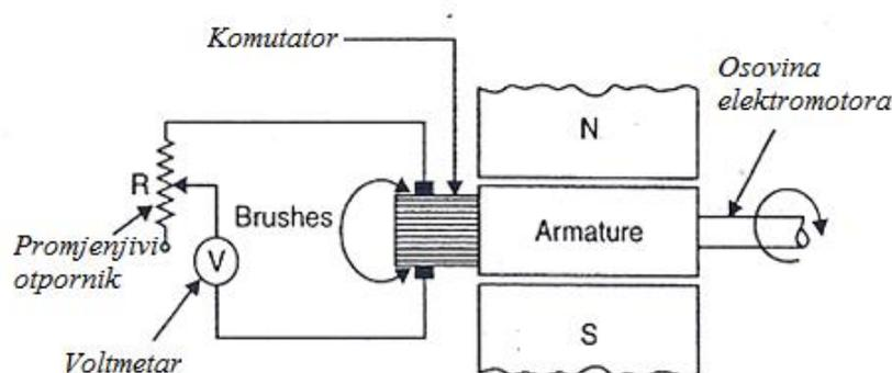
Slika 2. Istosmjerni tahogenerator s permanentnom uzbuđenom[5]
