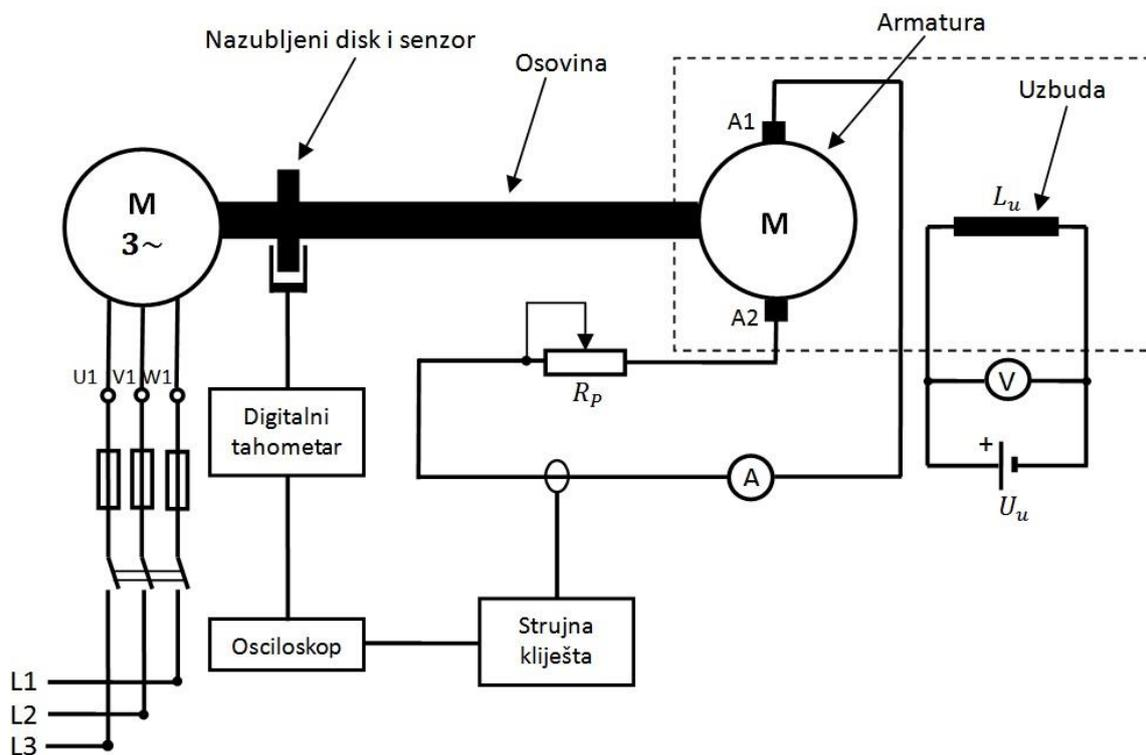
Slika 34. Shema spoja kod određivanja dinamičke karakteristike
