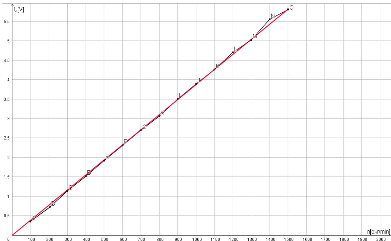
Slika 33. Statička karakteristika digitalnog tahometra
