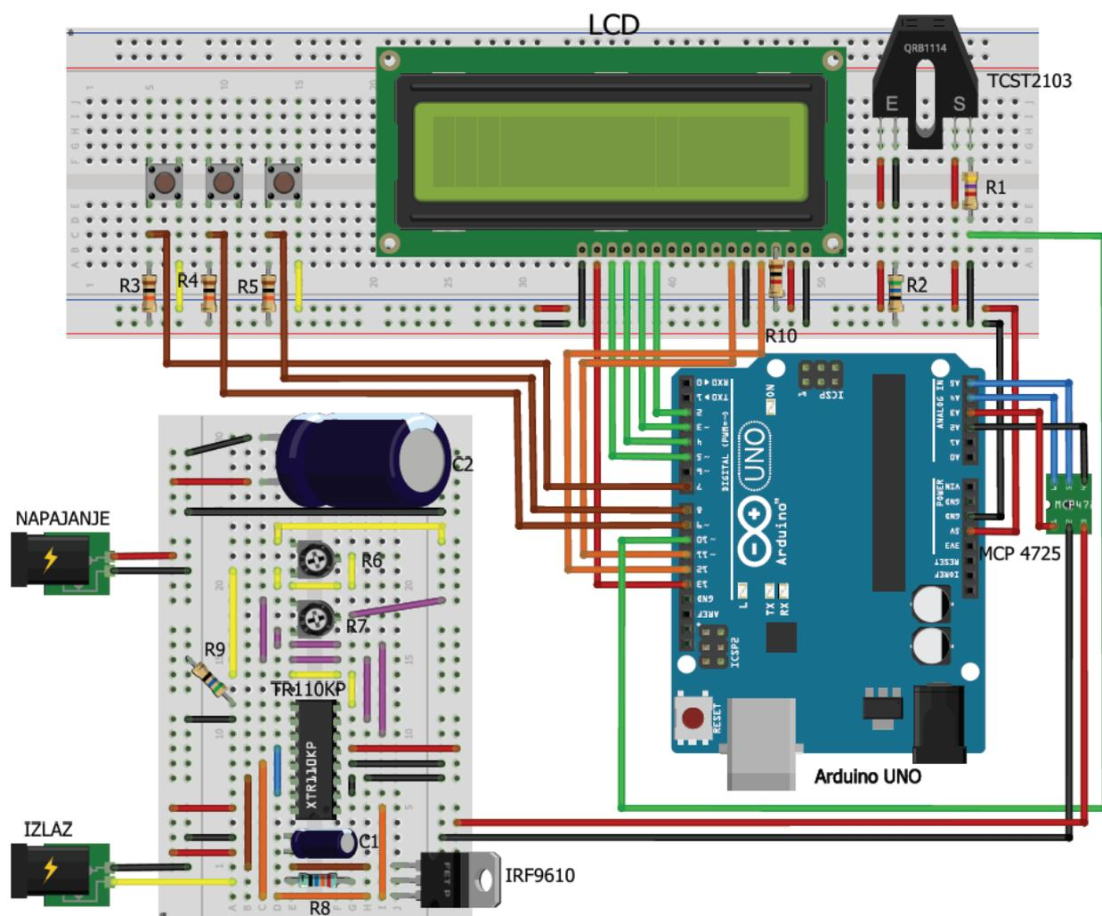
Slika 29. Montažna shema prototipa digitalnog mjerača broja okretaja
