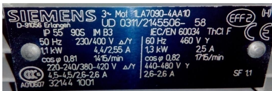
Slika 31. Podaci sa pločice trofaznog asinkronog motora
