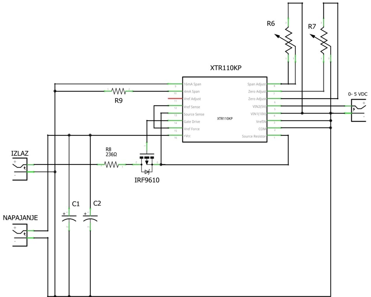
Slika 28. Električna shema XTR110KP U/I pretvornika
