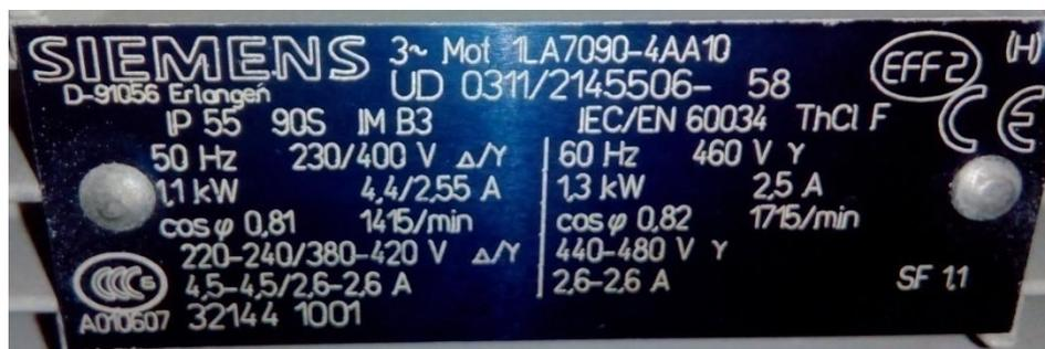
Slika 31. Podaci sa pločice trofaznog asinkronog motora
