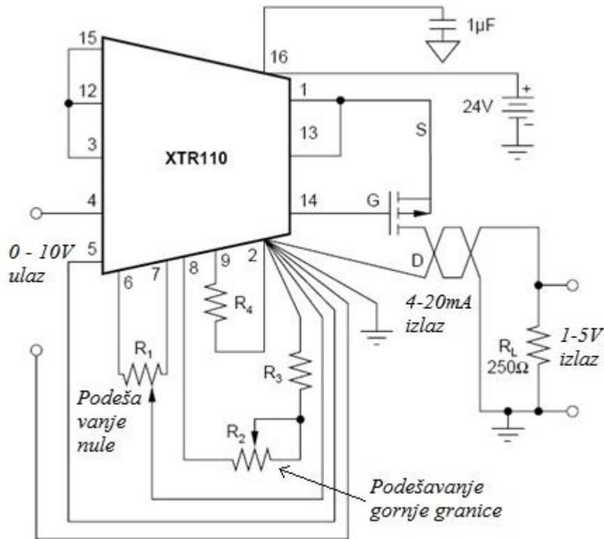
Slika 25. Umjeravanje XTR110 pretvornika[14]
