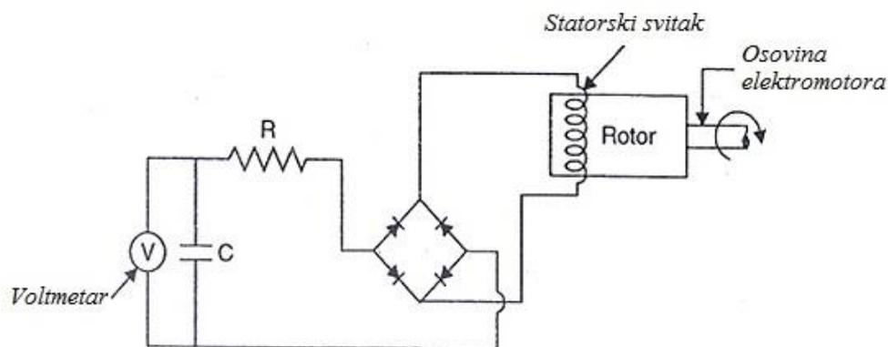
Slika 4. Izmjenični sinkroni tahogenerator u izvedbi jednofaznog napona[5]
