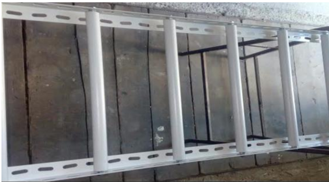
Slika 8. Spajanje valjaka i L-profila
