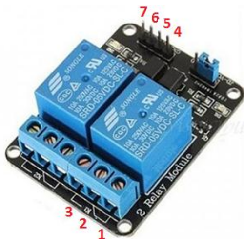
Slika 26. Relejni modul i oznake
