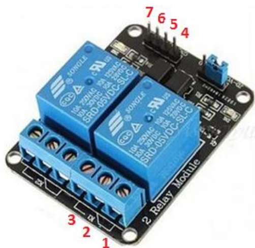
Slika 26. Relejni modul i oznake
