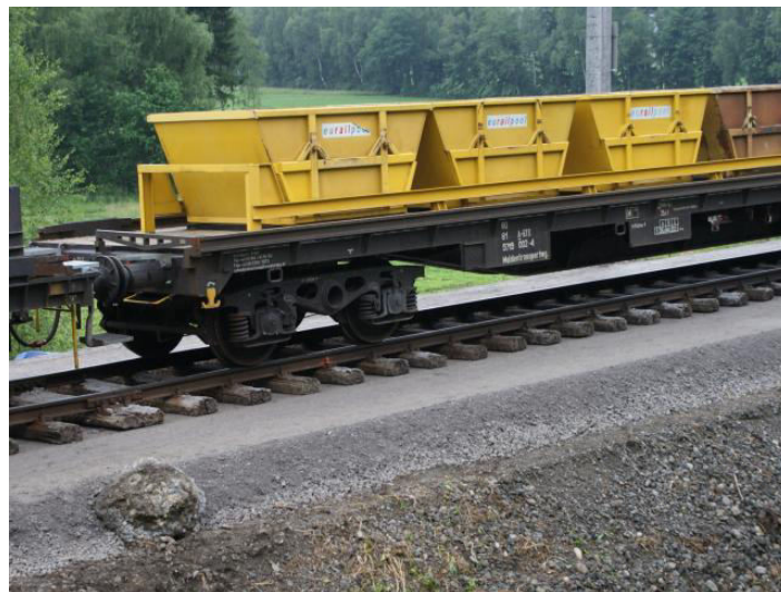
Slika 9. Vagon sa metalnim spremnicima (kible) [9]
