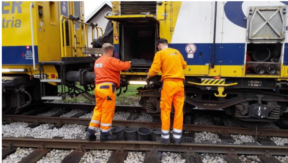
Slika 32. Istovar otpada (praha) u metalne posude [13]
