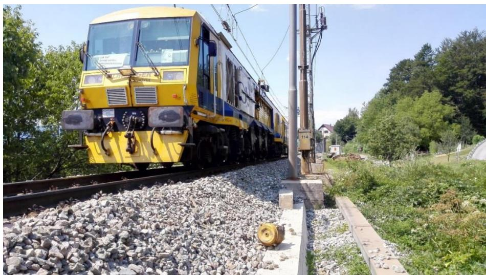
*Slika 30. Stroj za reprofiliranje tračnica [13]*
