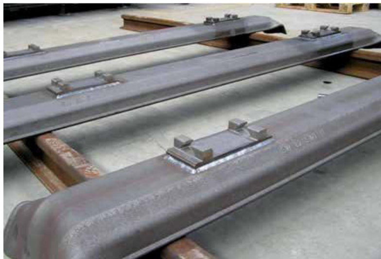
Slika broj 24. Čelični pragovi u tvornici DIV d.o.o. u Kninu [15]
