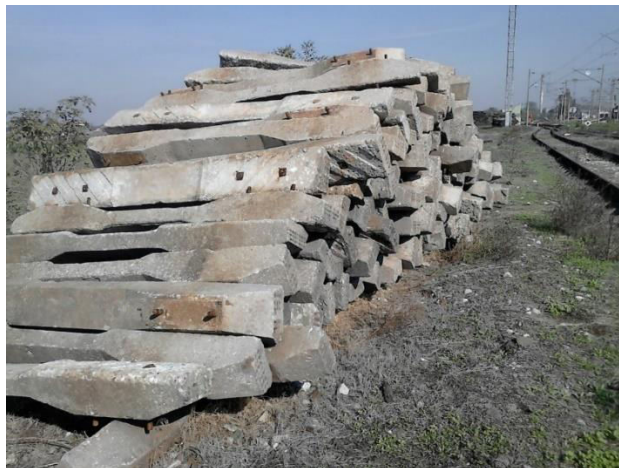
Slika 23. Deponija starih betonskih pragova u kolodvoru Vinkovci [13]
