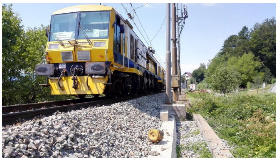
Slika 30. Stroj za reprofiliranje tračnica [13]
