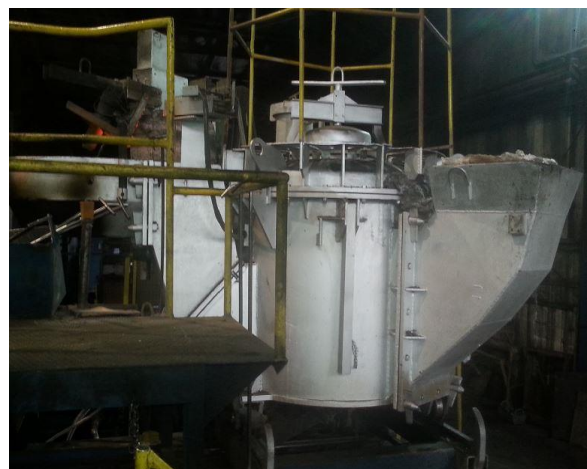
Slika 2.15 Kanalna indukcijska peć [9]
