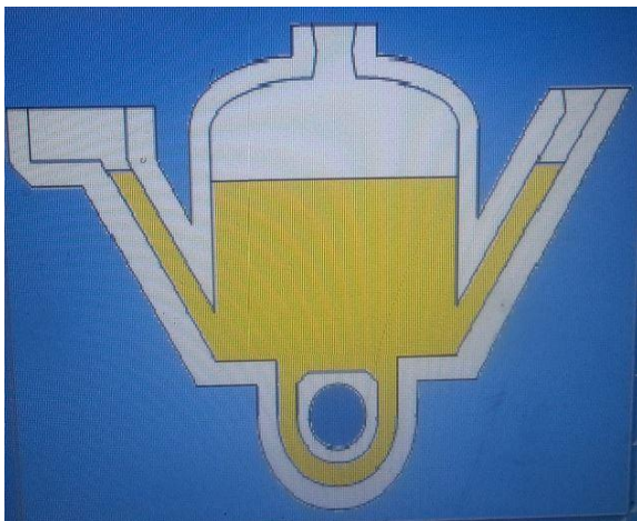
Slika 2.15 Kanalna indukcijska peć [9]
