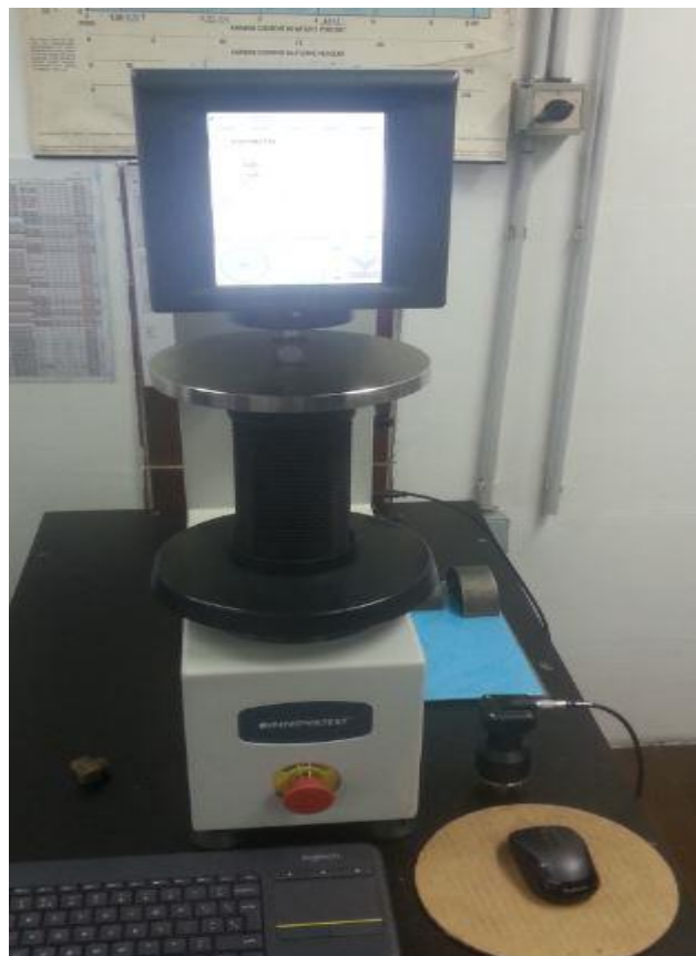
Slika 3.19 Uređaj za mjerenje tvrdoće ispitnog uzorka [9]
