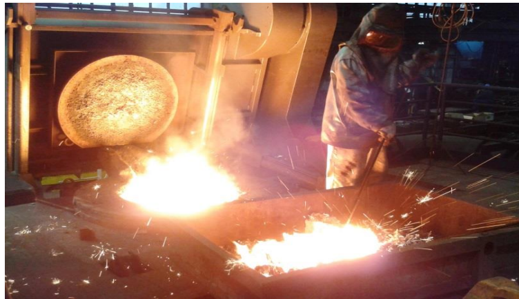
Slika 3.4 Ručno čišćenje troske [9]
