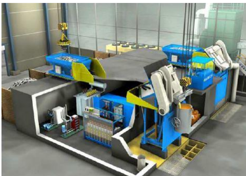
Slika 2.14 Indukcijska peć s dva lonca [16]
