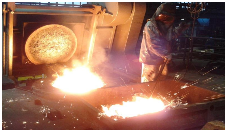
Slika 3.4 Ručno čišćenje troske [9]
