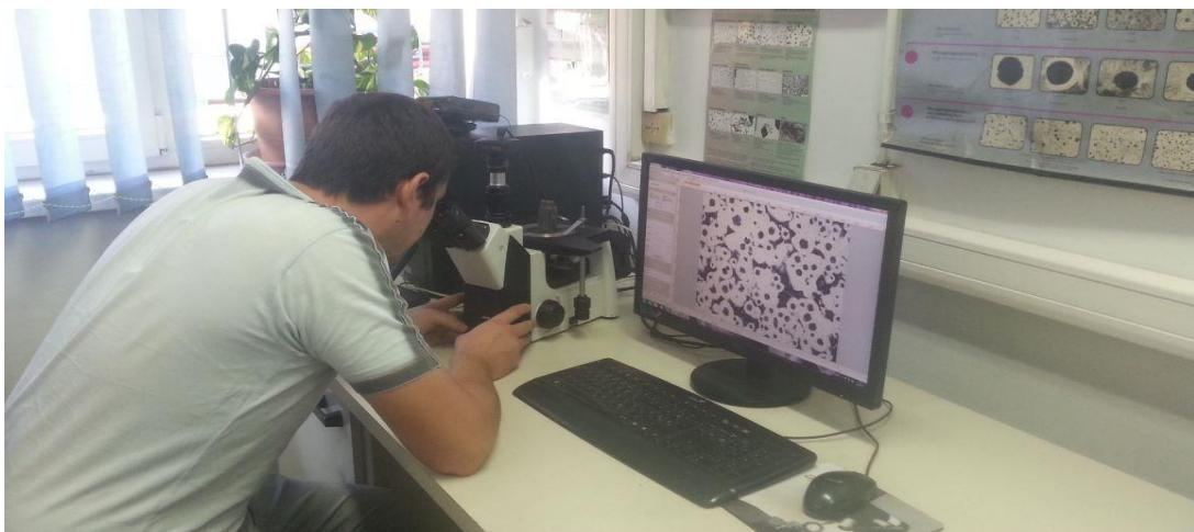
Slika 3.11 Metalografska ispitivanja optičkim mikroskopom [9]
