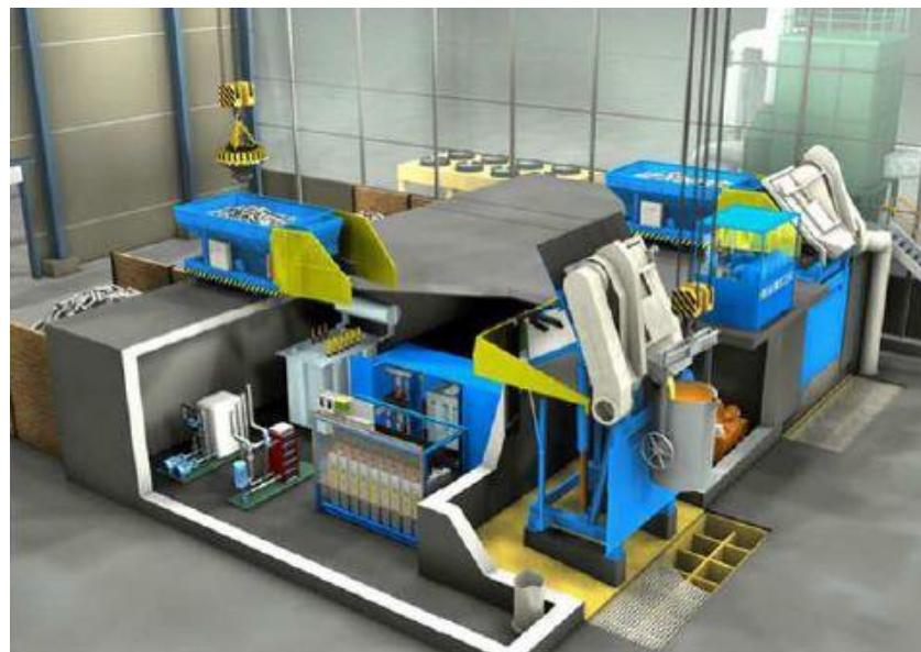
Slika 2.14 Indukcijska peć s dva lonca [16]
