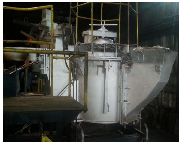
Slika 2.15 Kanalna induksijska peć [9]
