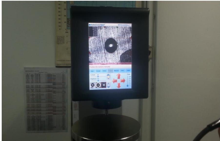
*Slika 3.20 Mjerenje promjera kalote [9]*
