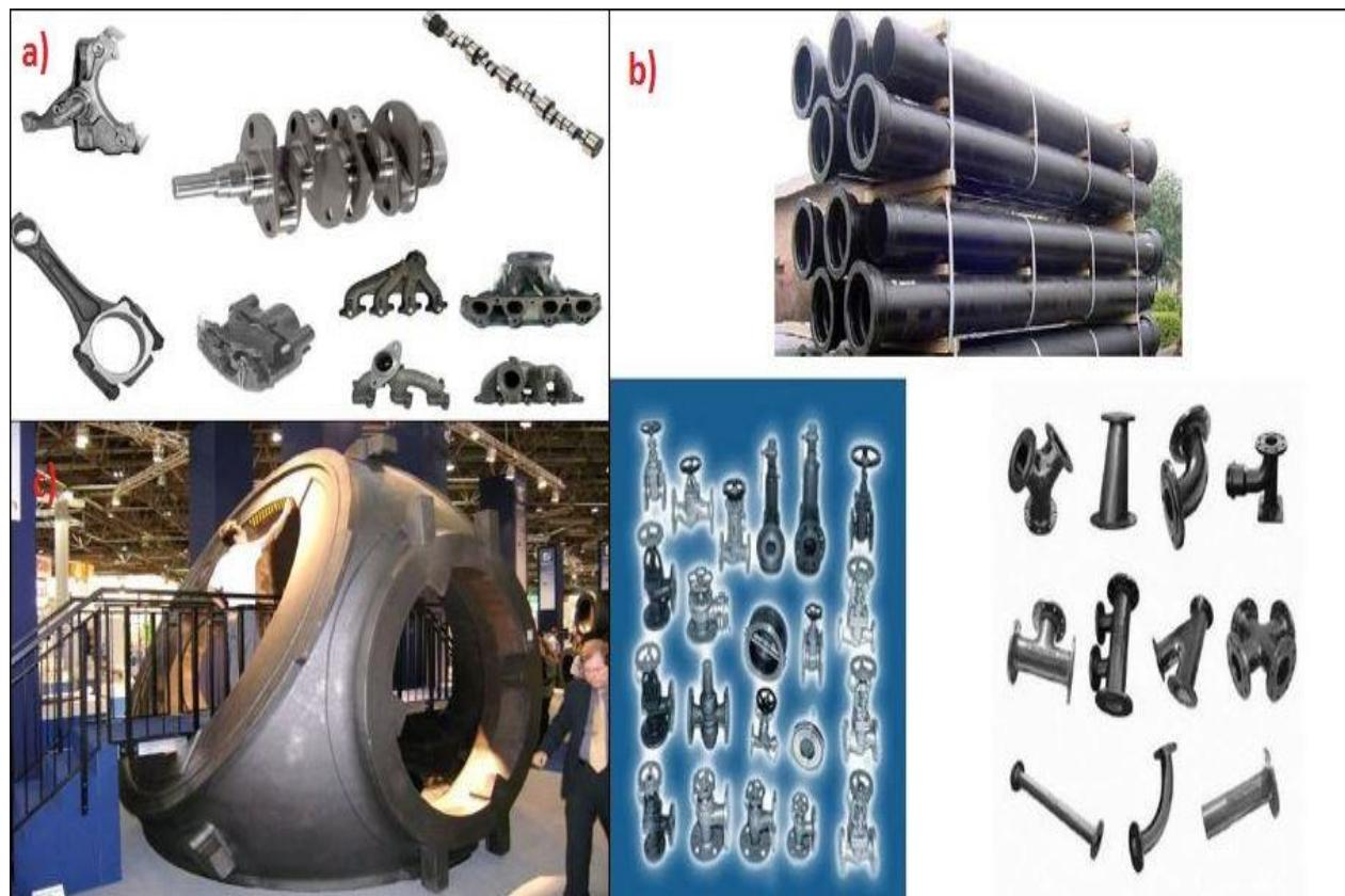
Slika 2.3 Područje primjene nodularnog lijeva [6]:
