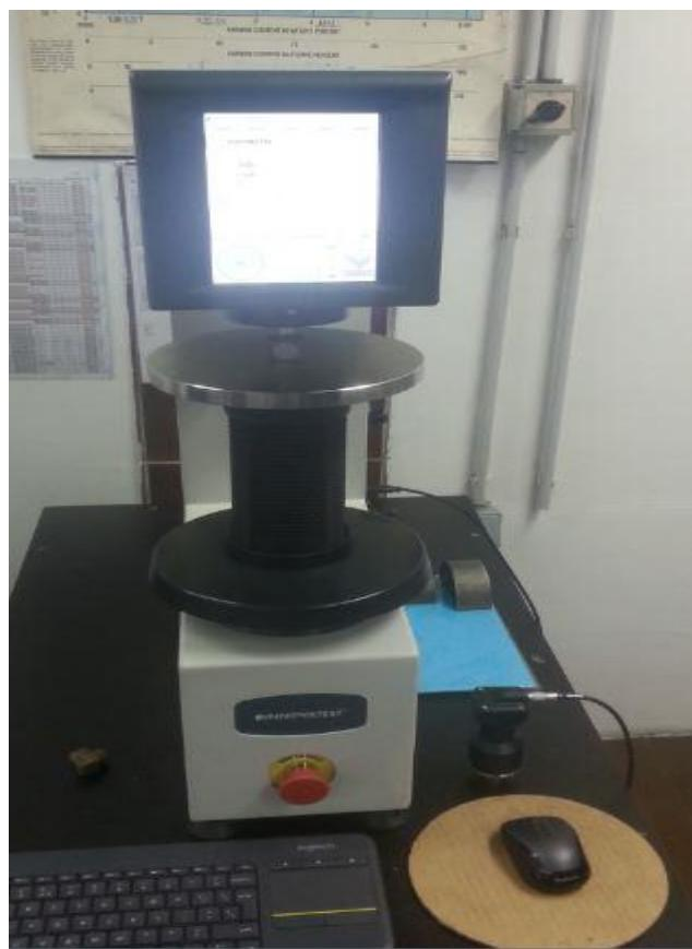
Slika 3.19 Uredaj za mjerenje tvrdoće ispitnog uzorka [9]
