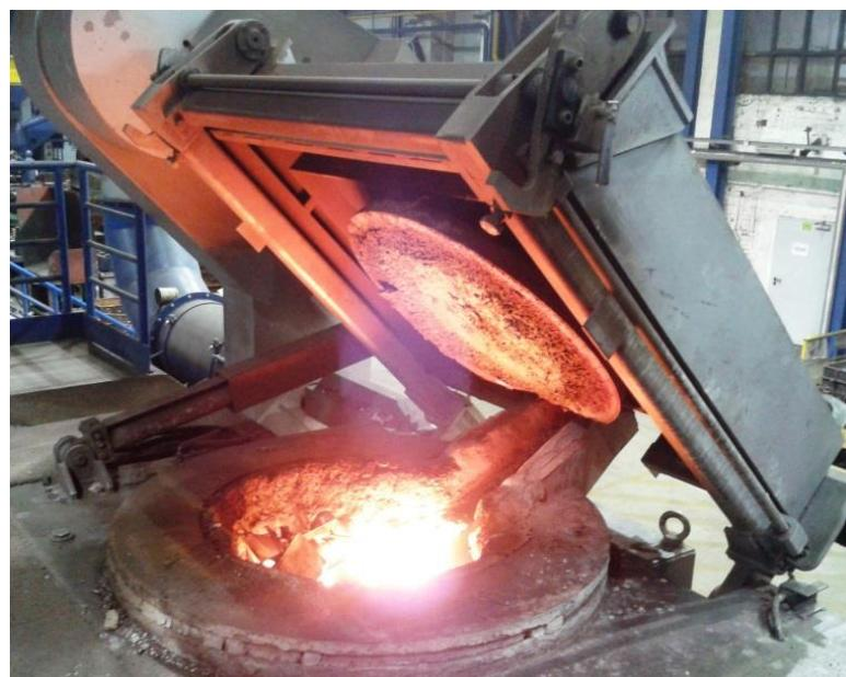
*Slika 3.3 Taljenje metalnog uloška [9]*
