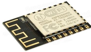
Slika 7.1 ESP 8266-12F mikroupravljač [10]
