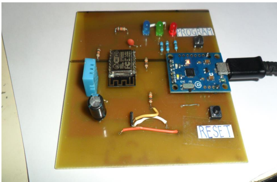
Slika 7.6 Tiskana pločica za rad sa ESP 8266-12F mikroupravljačem
