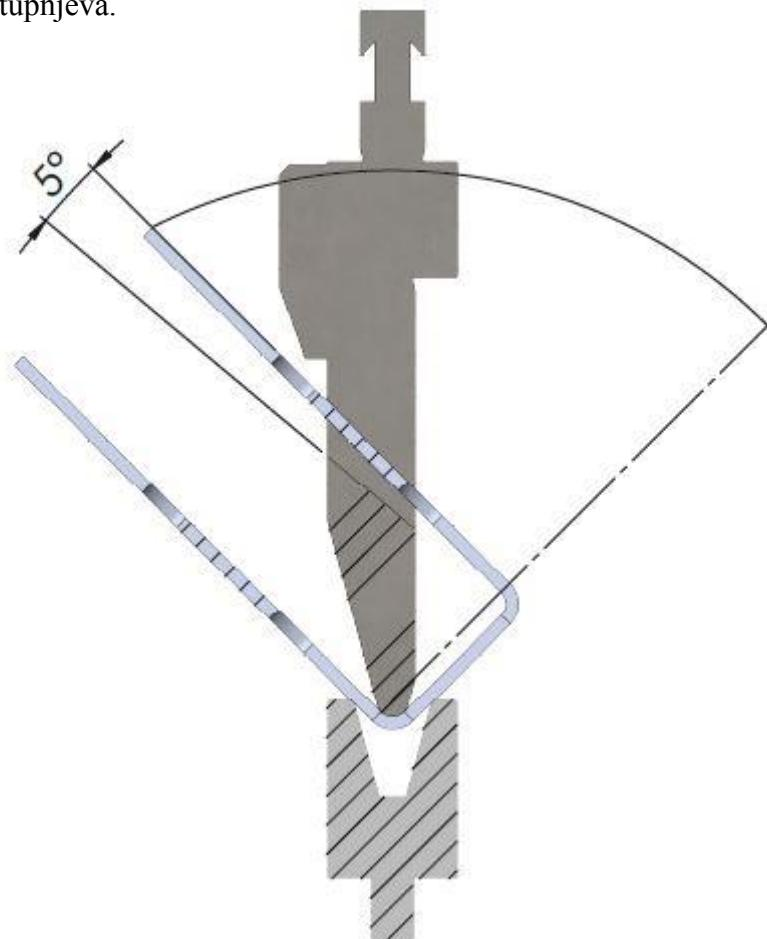
**Slika 2.3** Upotreba doradenog standardnog alata za savijanje
