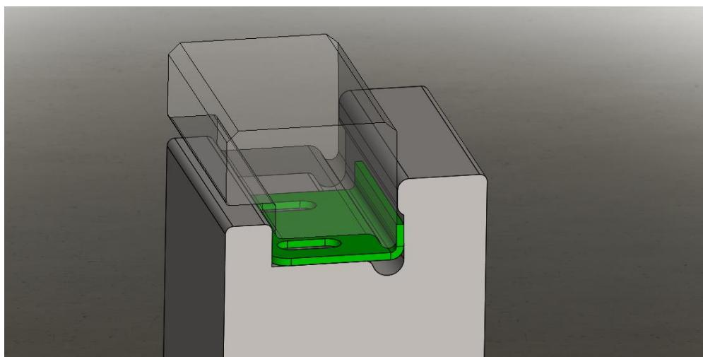
**Slika 3.8** Specijalni alat za savijanje 2 u otvorenom položaju
