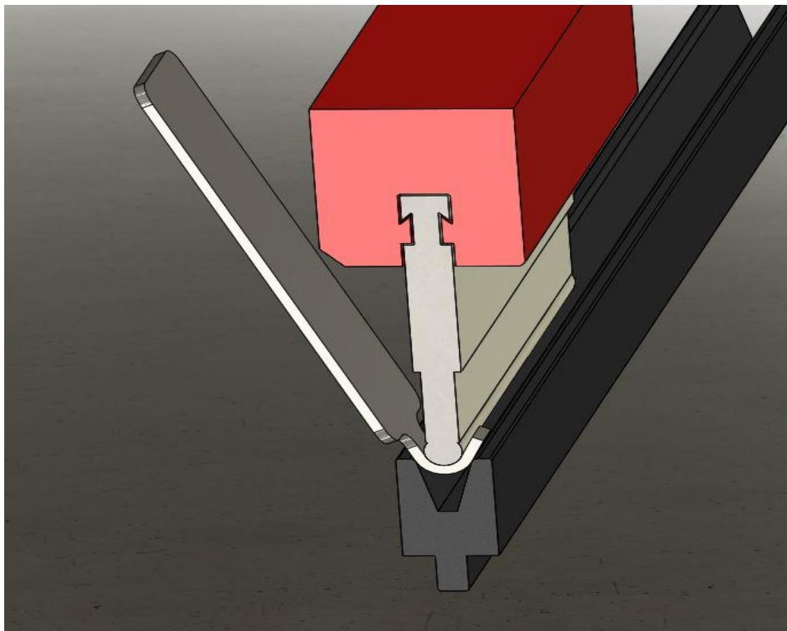
**Slika 3.5** Predsavijanje na CNC savijačici
