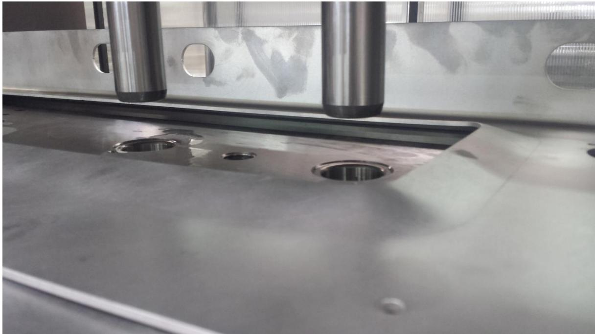
**Slika 3.21** Podešavanje hoda specijalnog alata za savijanje 3
