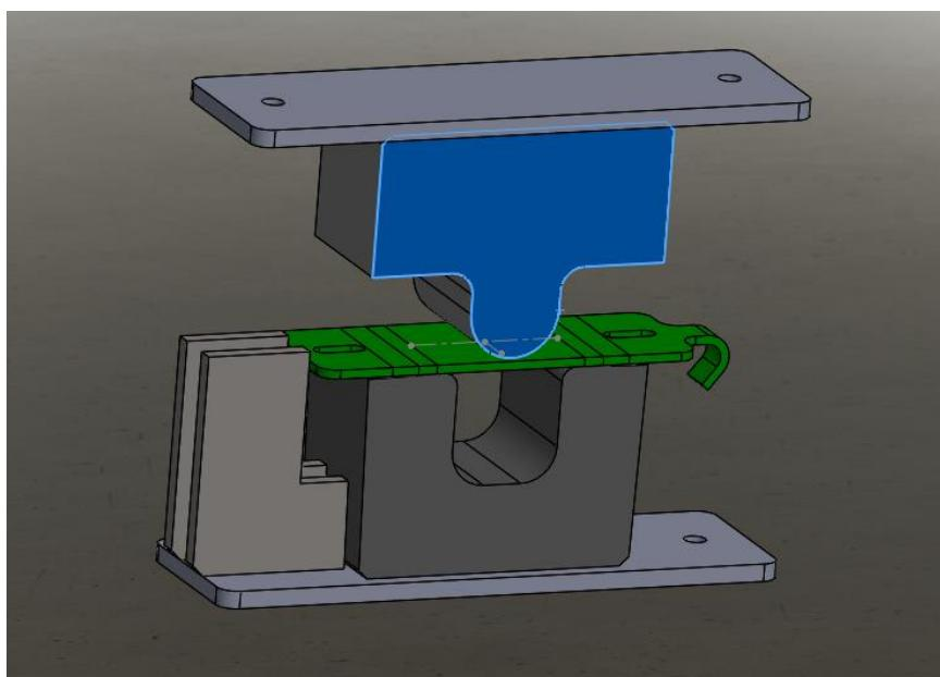
**Slika 3.1** Specijalni alat 1 u otvorenom stanju
