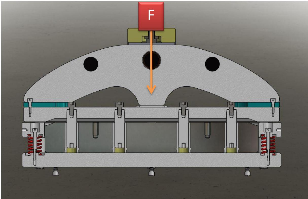
**Slika 3.13** Dizajn specijalnog alata za savijanje 3
