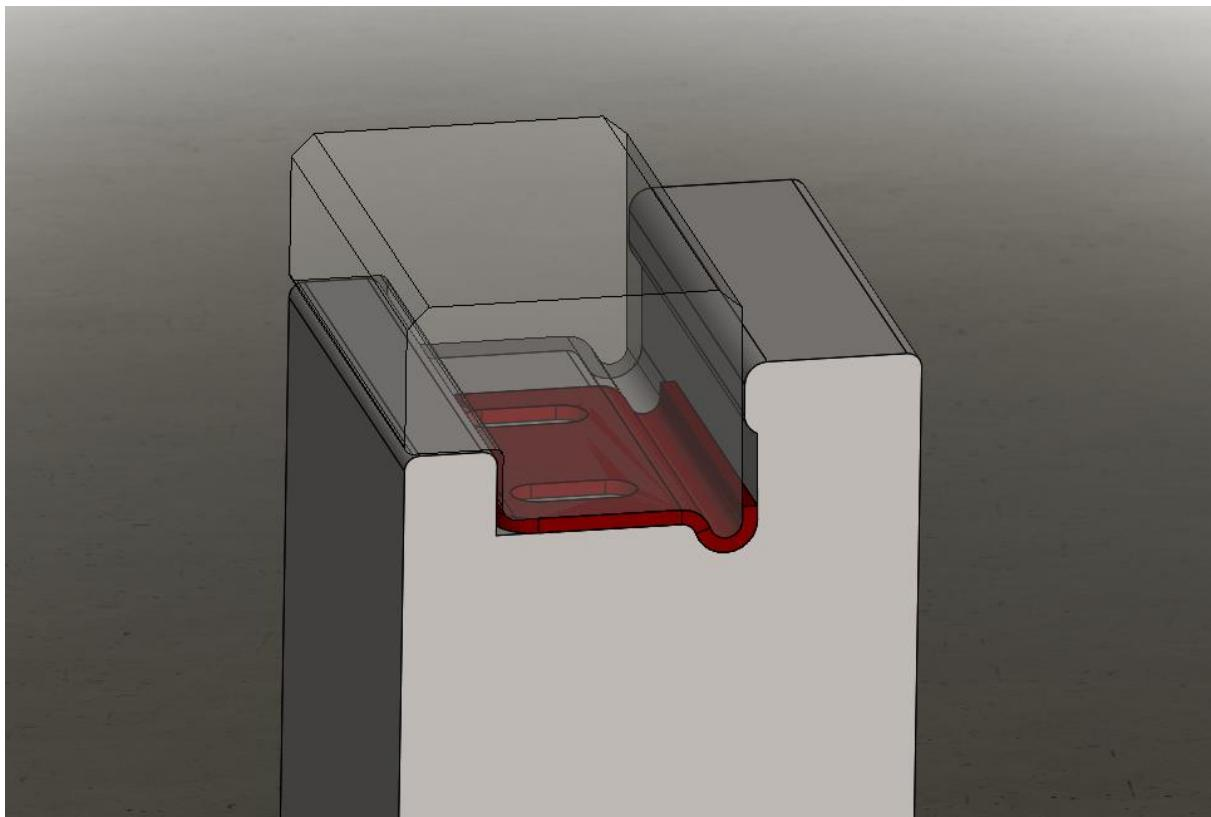
**Slika 3.7** Specijalni alat broj 2 u zatvorenom stanju
