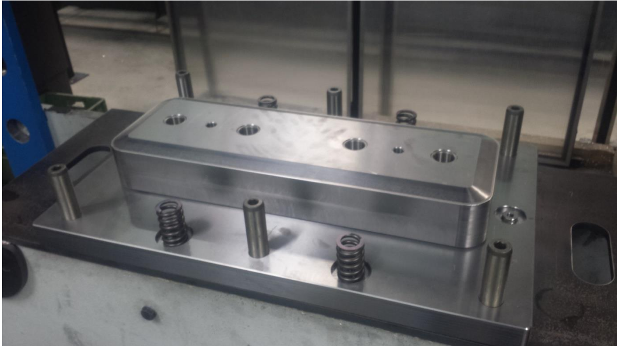
Slika 3.15 Temeljna ploča sa oprugama, vodilicama i jezgrom
