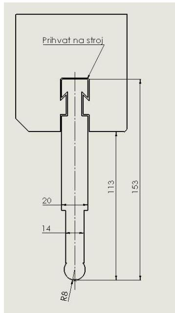
**Slika 2.1** Gornji dio standardnog alata za savijanje
