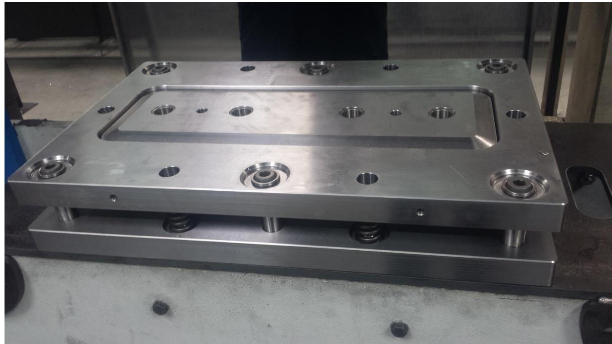
**Slika 3.19** Prikaz pridržavajuće ploče montirane na opruge i vodilice
