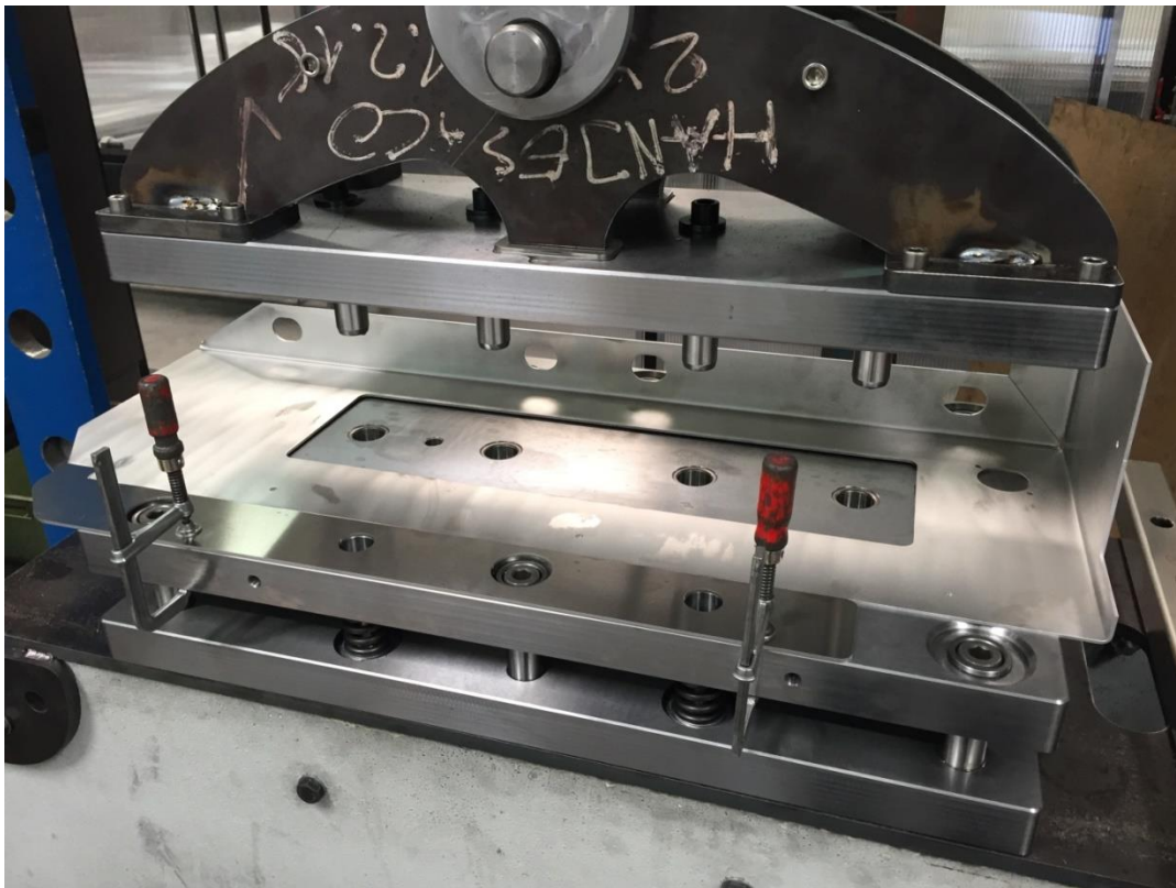
Slika 3.20 Probno savijanje sa specijalnim alatom za savijanje broj 3
