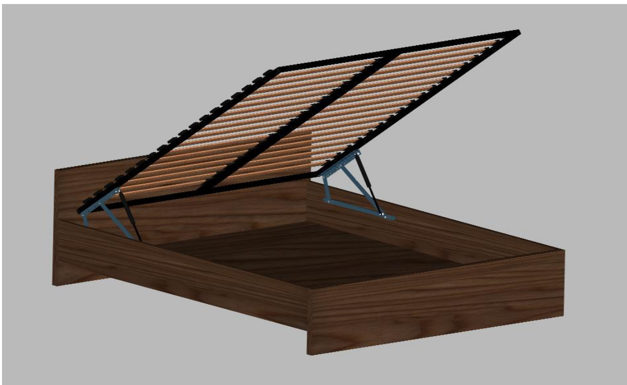
Slika 1.8. francuski ležaj sa dvostrukom podnicom i mehanizmom za podizanje
