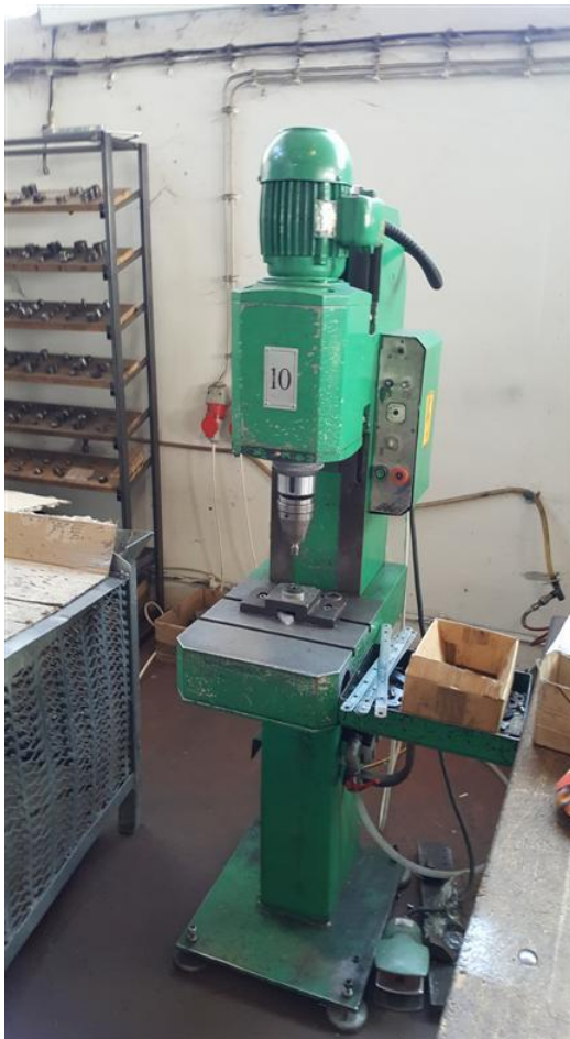
Slika 9.5.4. Univerzalni rotacioni stroj za zakivanje
