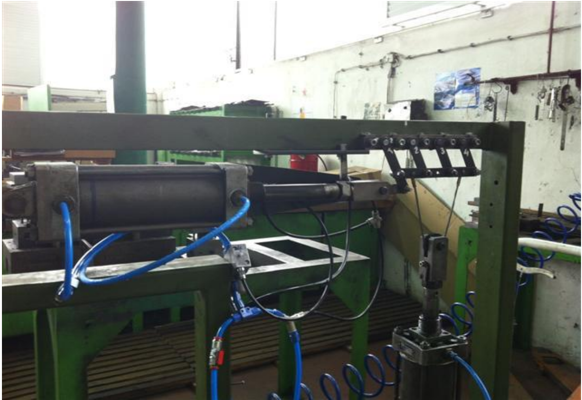
Slika 9.4.3. Naprava za testiranje zakovica i zakovanih spojeva
