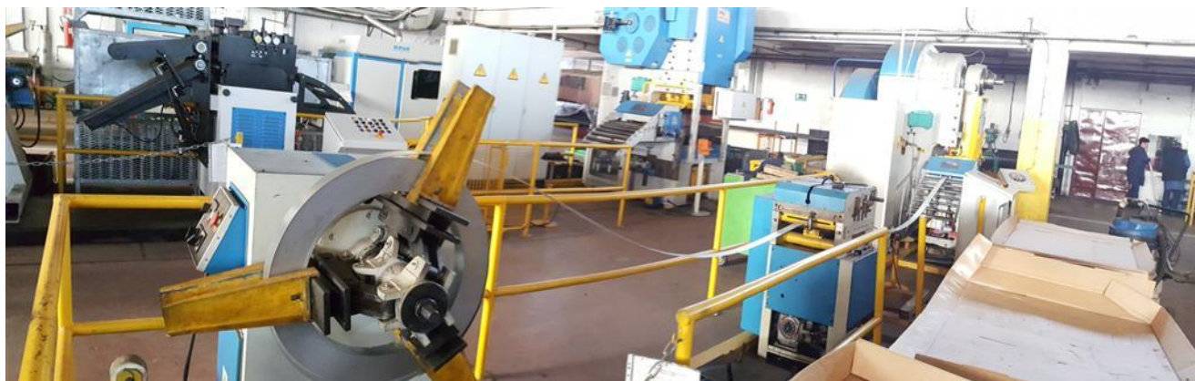
Slika 9.5.2. Linija za štancanje sa prešom od 160 tona
